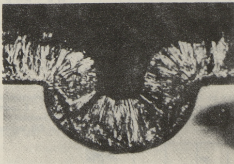
Фиг. 4. Разрез канавки в подложке при частичном заполнении ее поликристаллическим кремнием.
