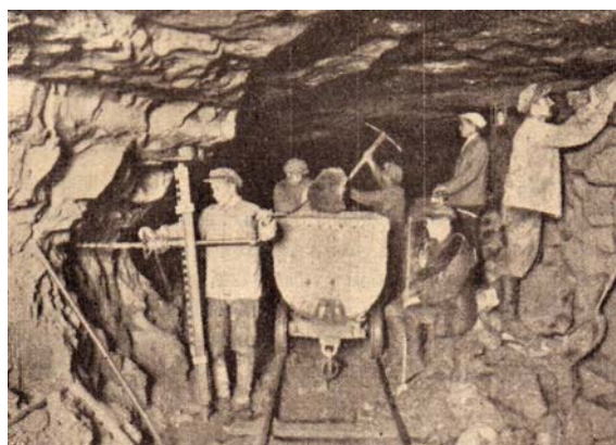
Joon. 4. Põlevkivi tootlemine allmaakaevandusest. Tööline vasakul puurib auku dünaamiitpadruni jaoks, keskel on näha allmaakaevanduse põlevkivi-vagonett.
