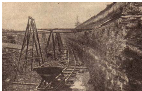
Joon. 3. Põlevkivi tootlemine lahtisest karjäärist. Paremäl on näha kattekihhist vabastatud põlevkivikihid, keskel - raudtee kohal - sillad paekivi ära vedamiseks kärudega.
