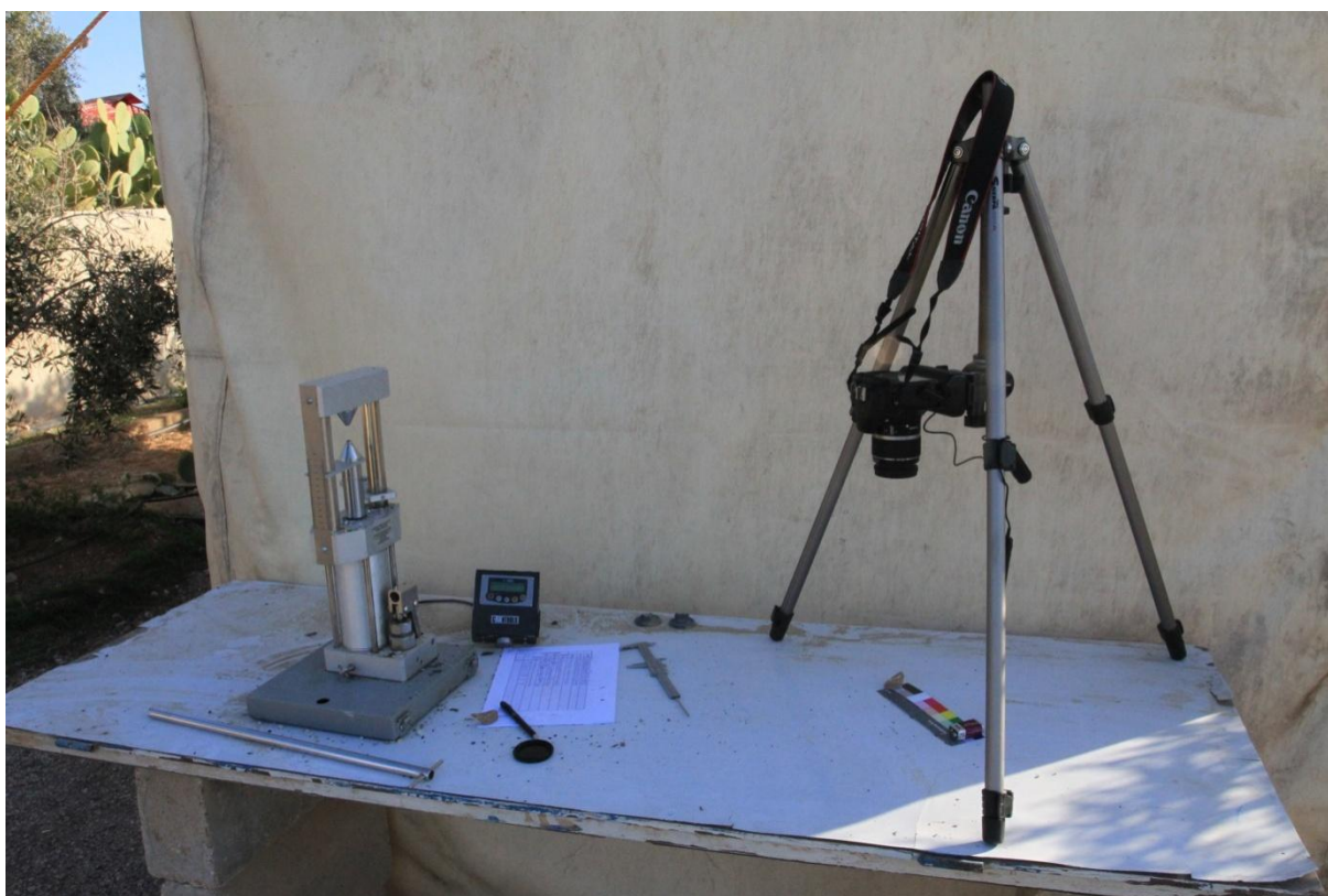
Joonis 10-1 Mäeinstituudi välilabor - punktkoormustest ja fotoaparaat
