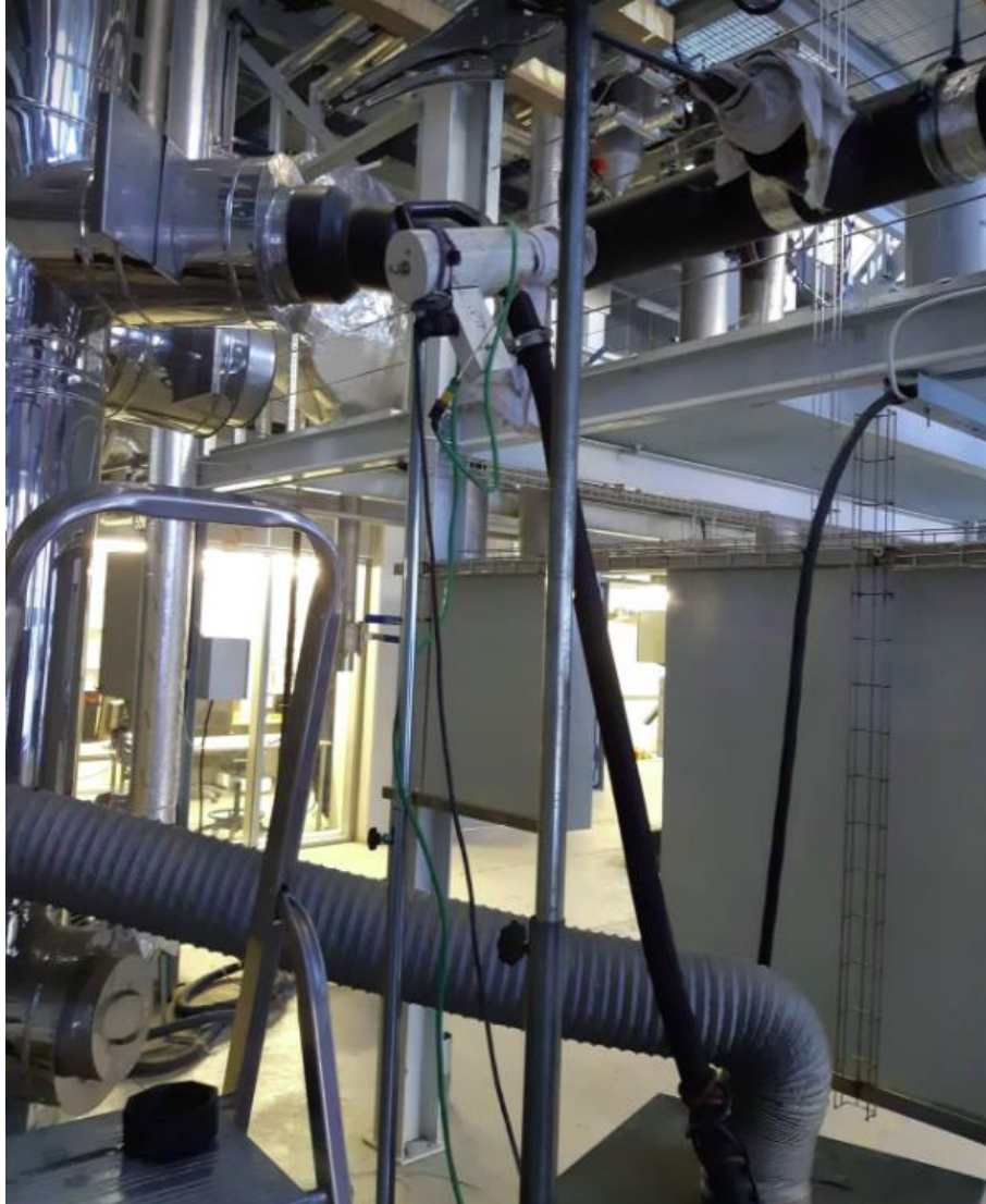
Joonis 2.4 FT-IR-i mõõtepea, koos termopaariga ahju suitsugaaside käigus
