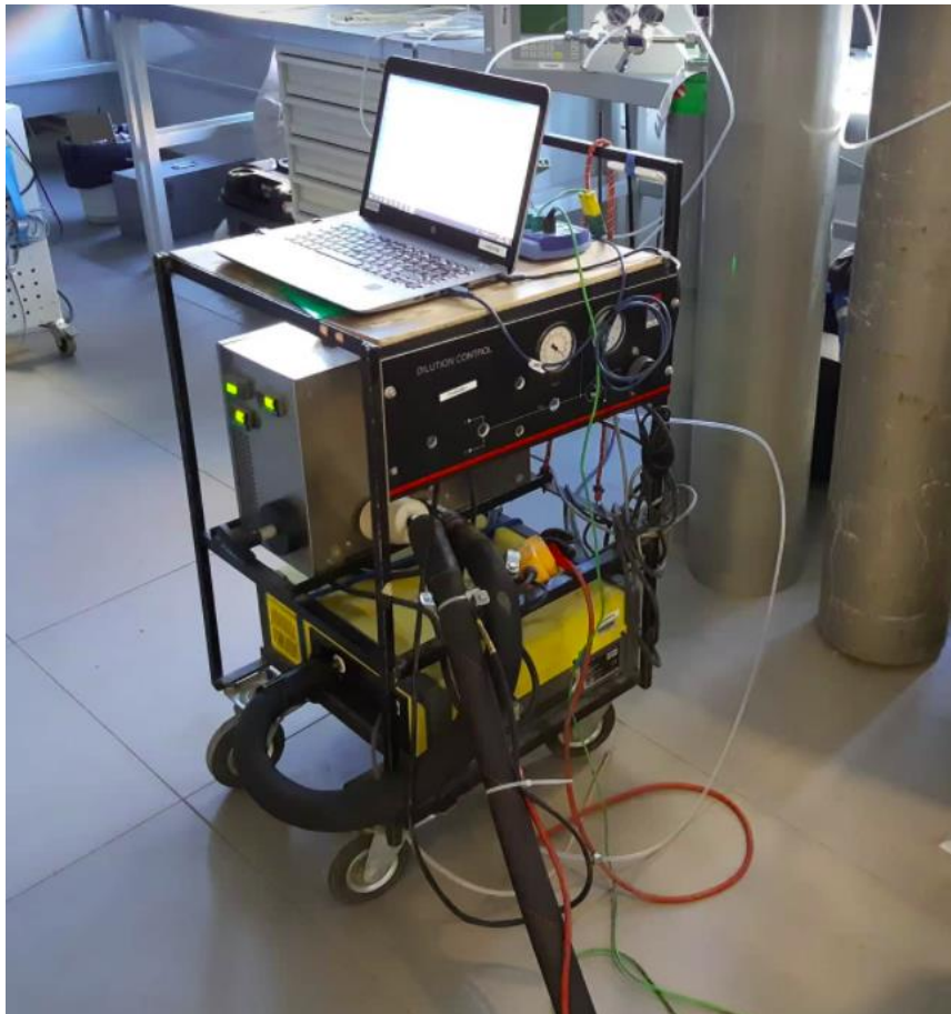
Joonis 2.3 FT-IR analüsaator laptopi all ja Pico andmekoguja laptopi taga
