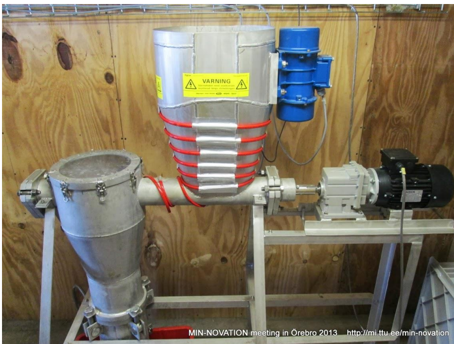
Joonis 15-6 Metallide leostumisseade metalli sisalduse määramiseks
