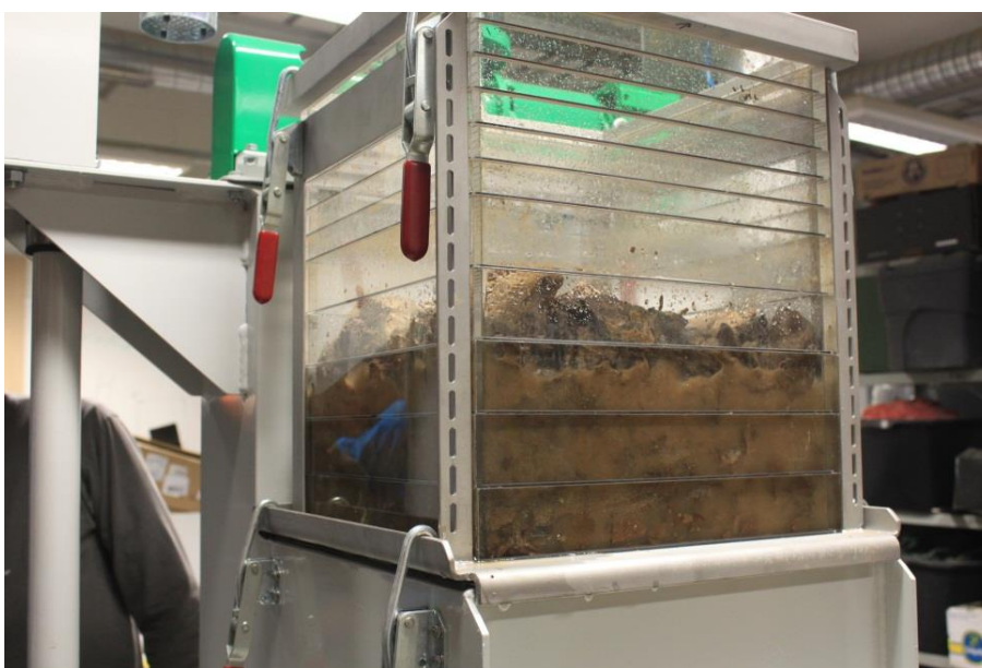
Joonis 15-3 Märgsepareerimise pilootseade
