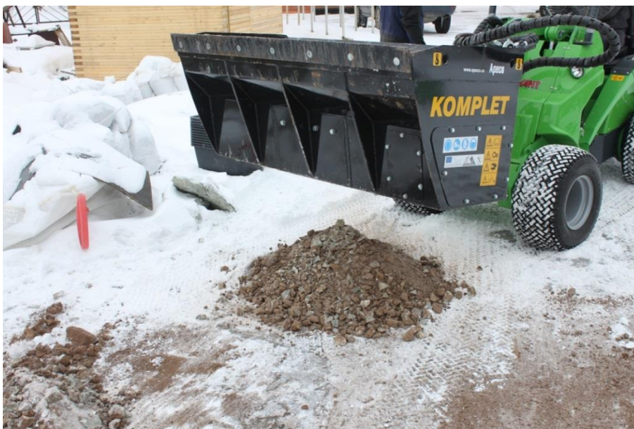
Joonis 15-8 Kiviõli Keemiatööstuse aheraine purustamise katsed
