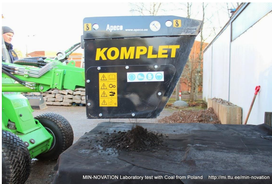
Joonis 15-11 Kivisöe kaevandamisjäägi testimine
