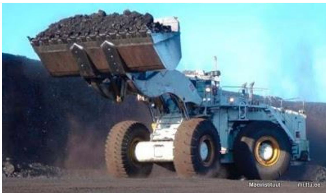
Joonis 4-4 Pealmaakopplaadur karjääris kivisütt kallurile laadimas
