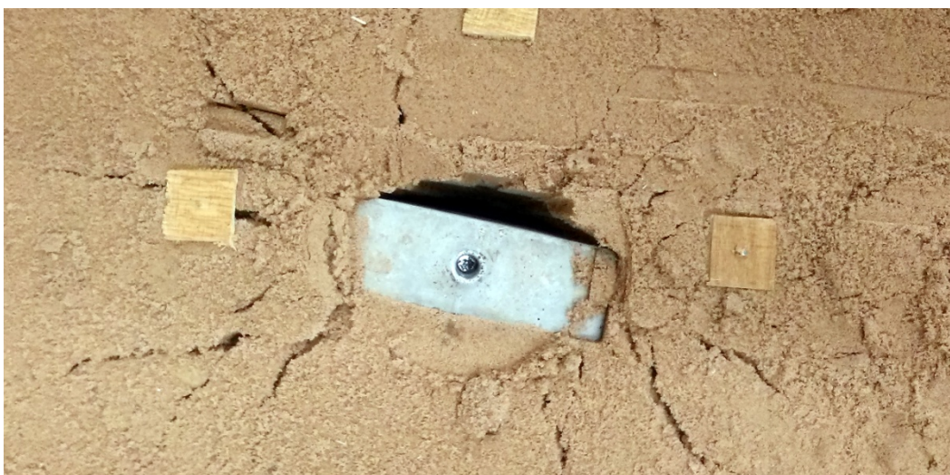
Joonis C.4. Ebaõnnestunud katse, 30/3/3. Vai süvistus viltu pinnasesse
