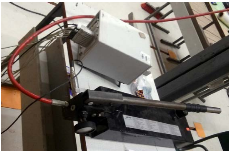
Joonis 3.7. Lukas LZM 25/200 survekatseseade
