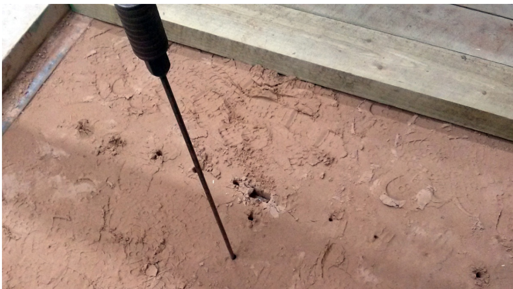
Joonis C.3. Tiheduse mõõtmine pika vardaga penetromeetriga kindlates punktides vaia ümber
