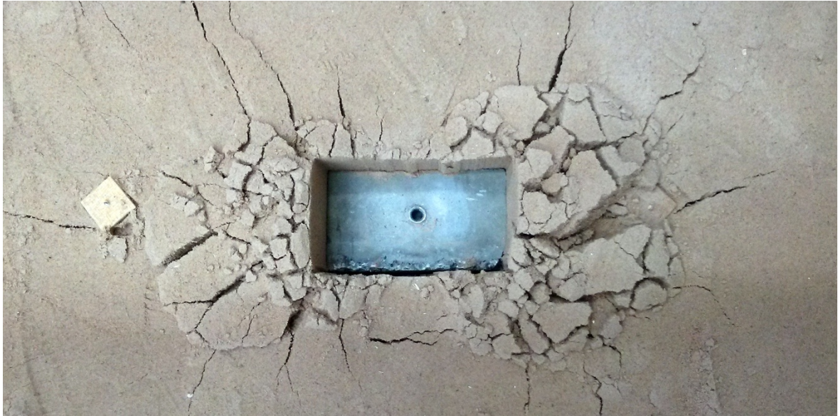
Joonis 4.16. KV40/6 mudeli süvistamisel kohevas pinnases toimunud pinnasedeformatsioon
