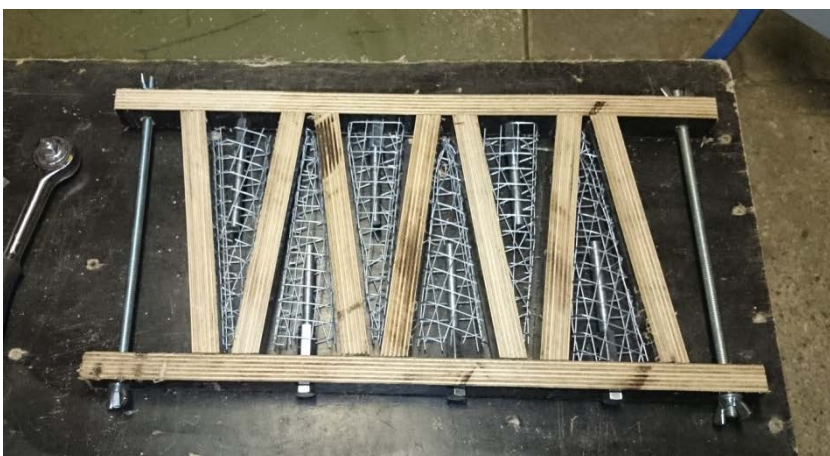
Joonis 3.3. Kiilvaimudelite valamisel kasutatud vorm ja armeering
