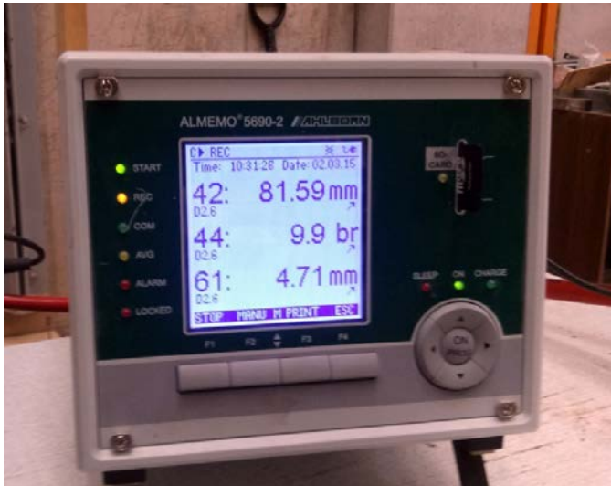
Joonis 3.6. ALMEMO 5690-2 AHLBORN andmesalvestuse süsteem
