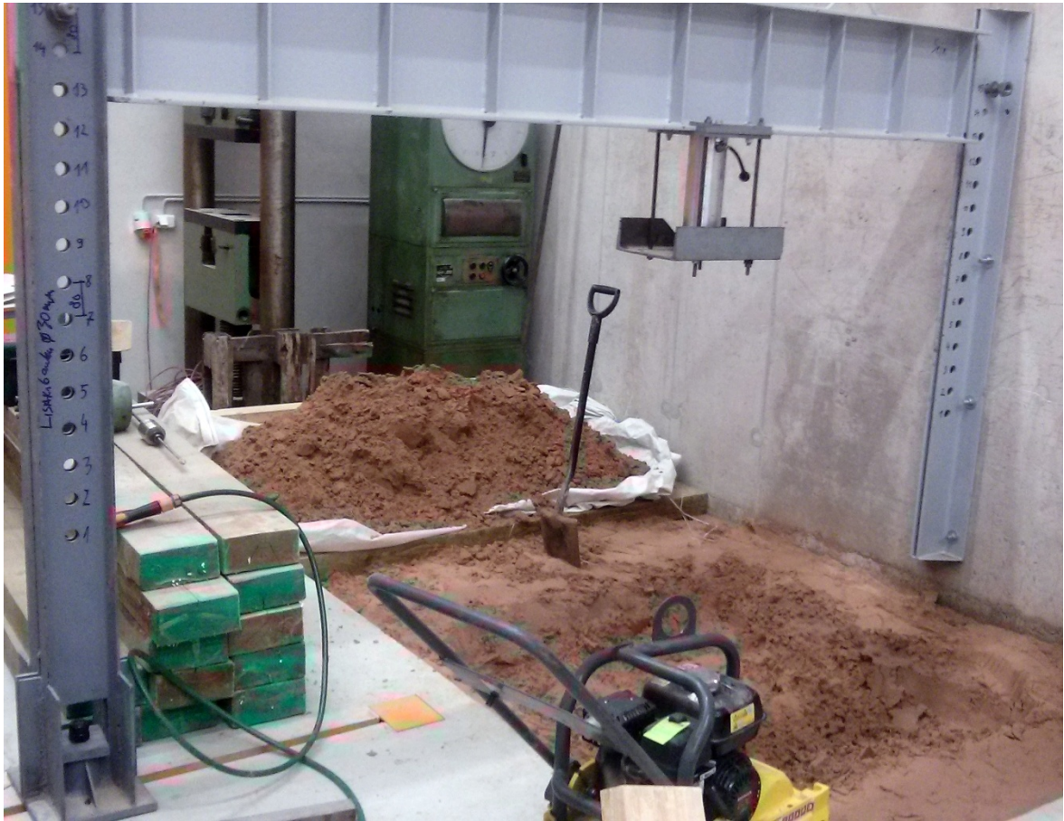
Joonis C.1. Pinnasekasti läbikaevamine ja plaatvibraatoriga tihendamine
