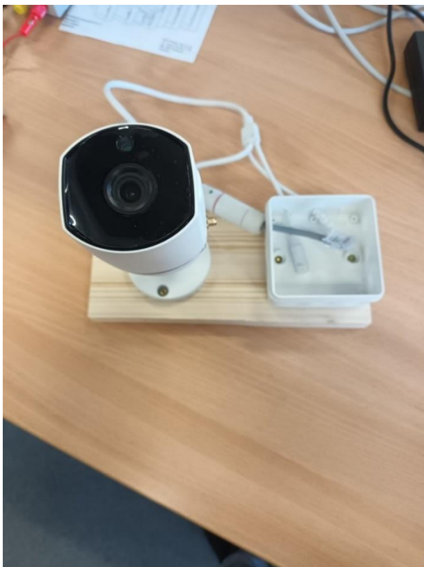
Joonis 4.1 Kaamera koos karbi ja alusega enne aknalauale paigaldamist
