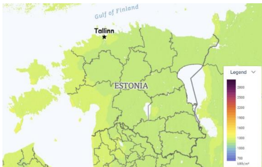
Joonis 1.2 Summaarne aastane optimaalse kaldenurgaga ( 40^\circ ) pinnale langev päikesekiirgus Eestis ( \text{kWh}/\text{m}^2 ) [10]
