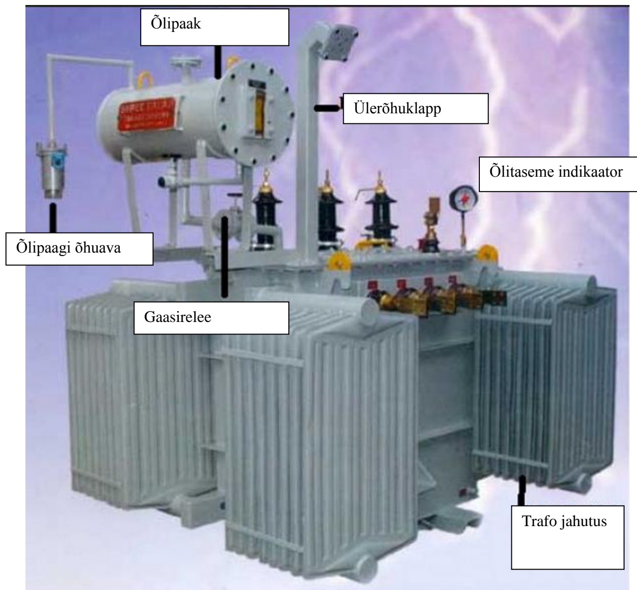
Joonis 4.2. Trafo primaarkaitse [6]
