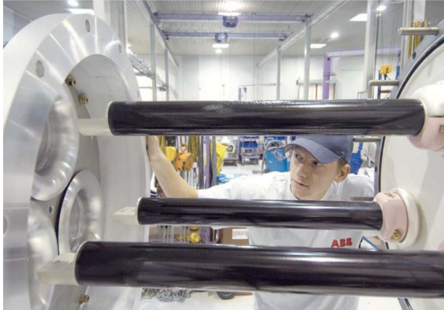
Joonis 3.2. GIS jaotla voolutrafo [4]
