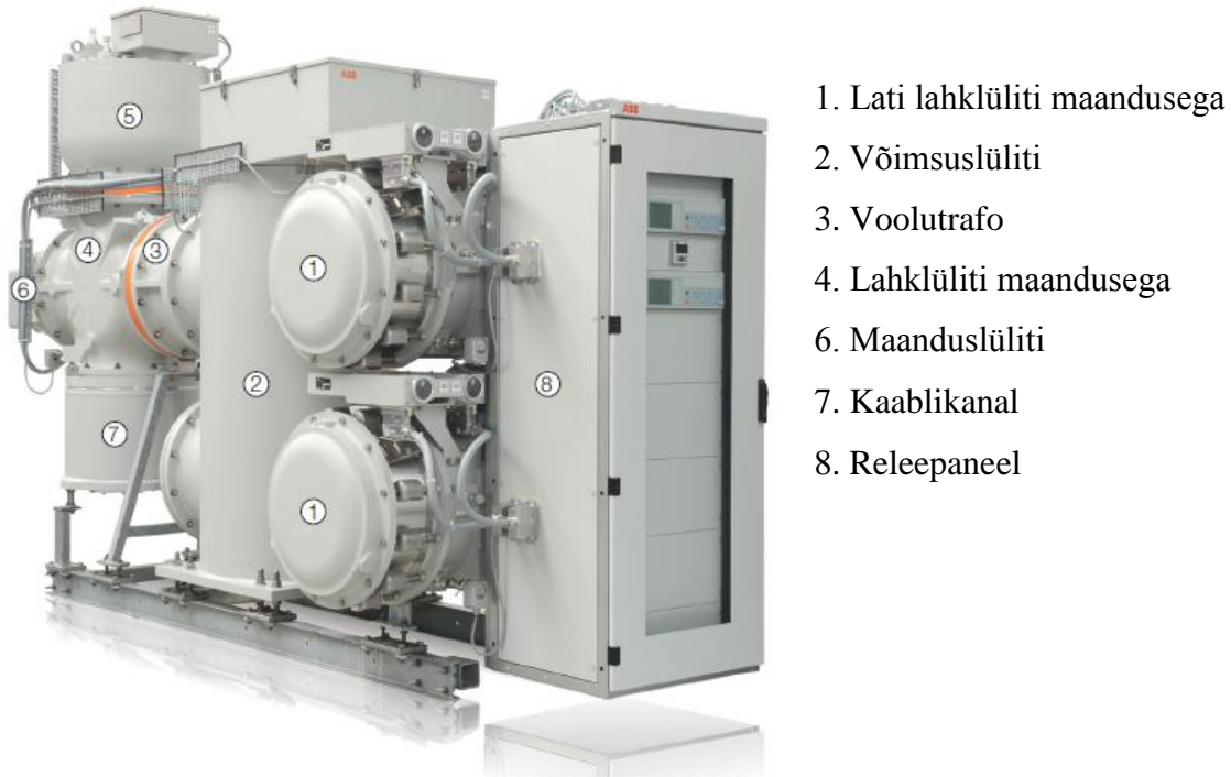
Joonis 3.1. GIS jaotla seadmed [4]
