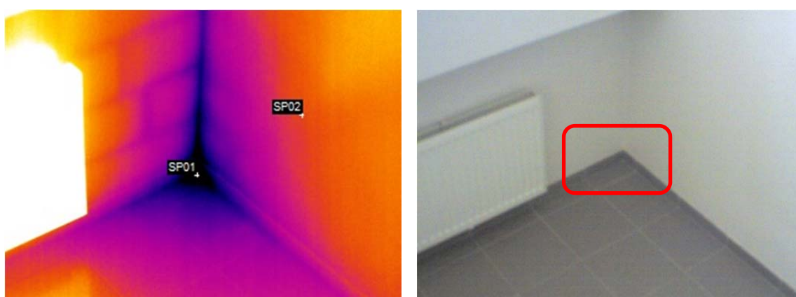
Joonis 4.3 Temperatuuriindeksi väärtused välisseina-vahelae liitekohas
