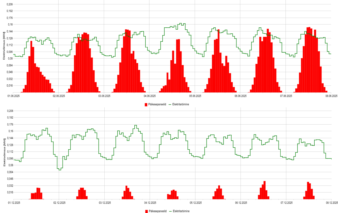
Joonis 2.5 Esimese stsenaariumi nädalane elektritootmise ja elektritarbimise graafik alates 1. juuni (ülemine) ja 1. detsember (alumine)
