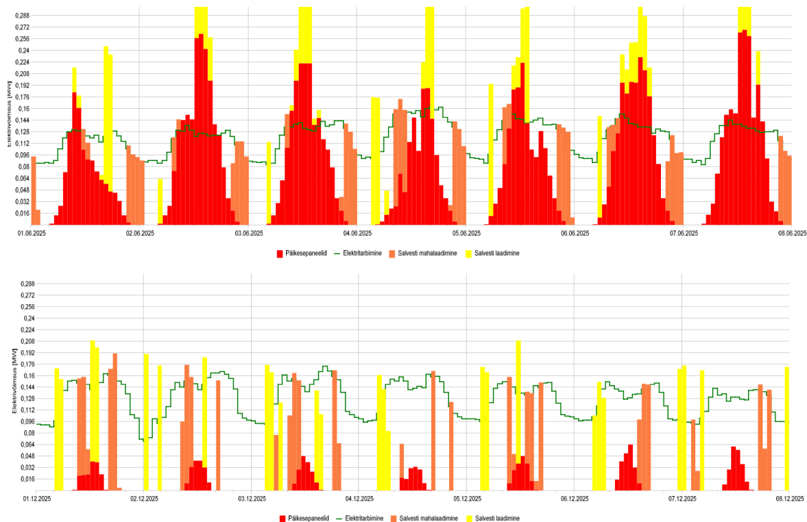
Joonis 2.11 Neljanda stsenaariumi nädalane elektritootmise ja elektritarbimise graafik alates 1. juuni (ülemine) ja 1. detsember (alumine)
