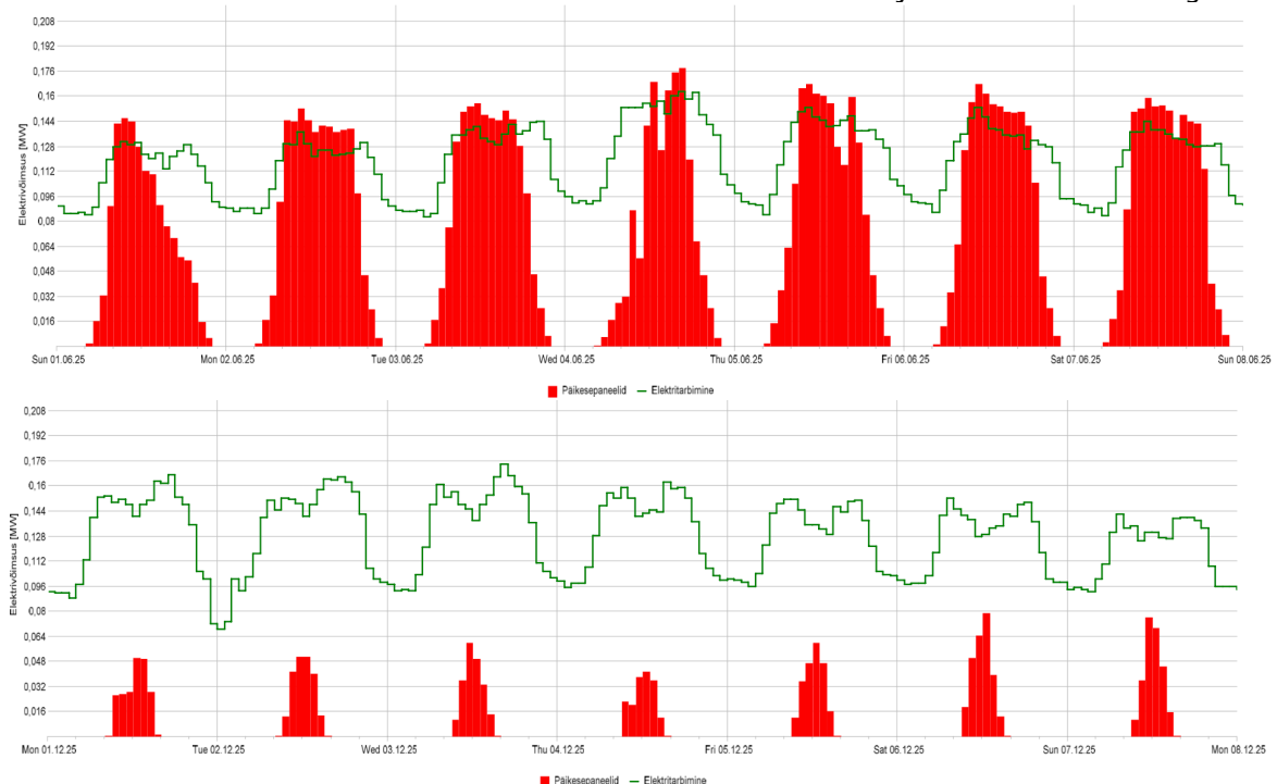
Joonis 2.15 Kuuenda stsenaariumi nädalane elektritootmise ja elektritarbimise graafik alates 1. juuni (ülemine) ja 1. detsember (alumine)
