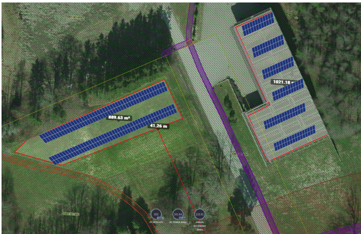
Joonis 1.16 Solaredge Designer joonestamise tarkvaraga planeeritud päikeseelektrijaamad Õru ja Looduspargi kinnistutele
