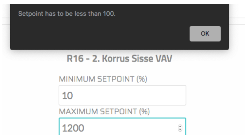
Joonis 4.1.3 Näide tarkvara poolt antavast tagasisidest, kus kasutaja on üritanud õhuvooluklapi maksimaalset seadepunkti lubatust kõrgemale seadistada.
