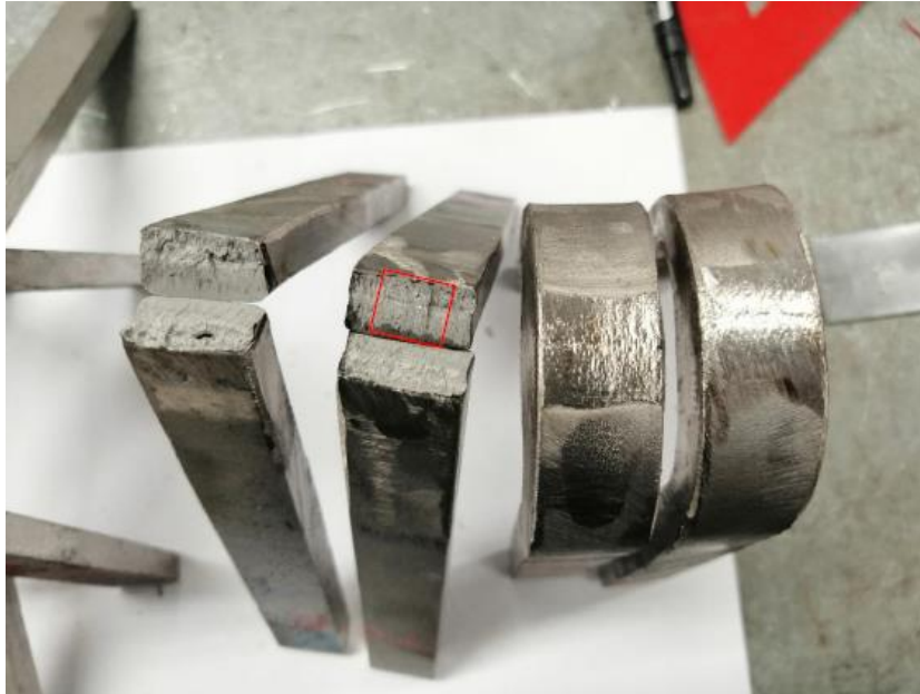
Joonis 2.7 Paindetesti katsetükid ja märgitud punasega uurimisala, mida uuritati SEM analüüsiga.
