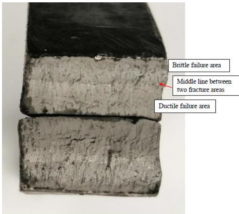
Joonis 2.8 Paindekatses purunenud katsekehde murdepinna skeem, mida kasutatid SEM ja EDS analüüsi tulemuste esitamiseks.
