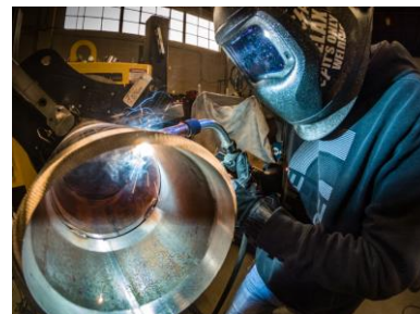
Joonis 1.3 MAG-keevitus täistraadiga tööprotsessi skeem (vasakul) ja foto (paremal) [15].
