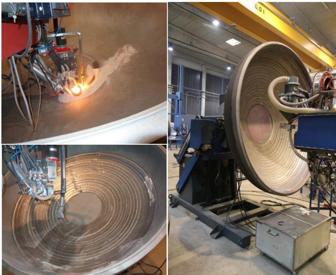
Joonis 1.9 Keevitusprotsess 721 - elekträrbukeevitus lintelektroodiga. Mahuti ots pealkeevitusega [1].
