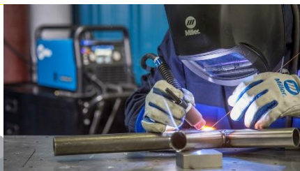
Joonis 1.4 - TIG-keevitus täisliisamaterjaliga tööprotsessi skeem (vasakul) ja foto (paremal) [20].
