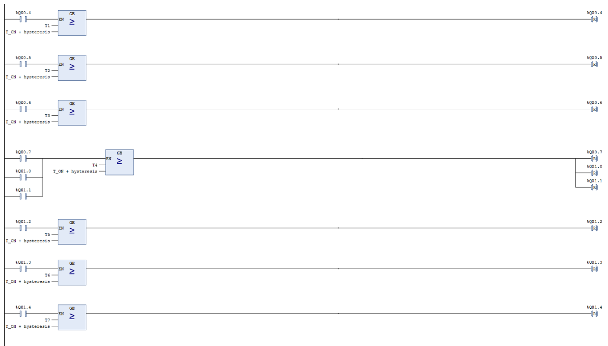
Рисунок 5.6 Алгоритм выключения обогрева трубопроводов.
