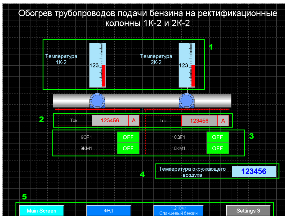
Рисунок 6.16 Экран обогрева трубопроводов подачи бензина на ректификационные колонны 1К-2 и 2К-2
