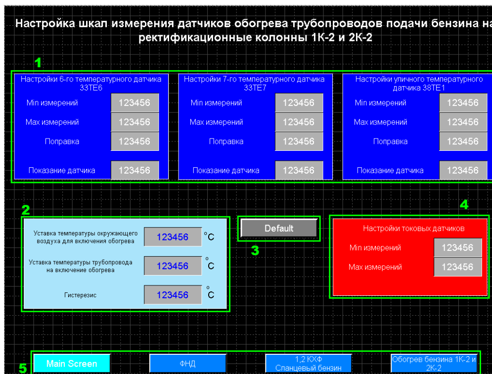
Рисунок 6.18 Рисунок 24. Настройки обогрева трубопроводов подачи бензина на ректификационные колонны 1К-2 и 2К-2.
