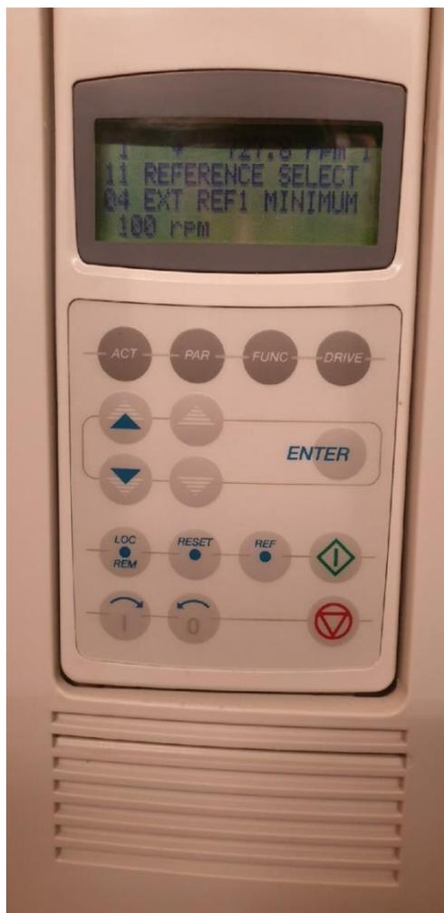
Рисунок 4.1. Данные частотного преобразователя ABB ACS 600
