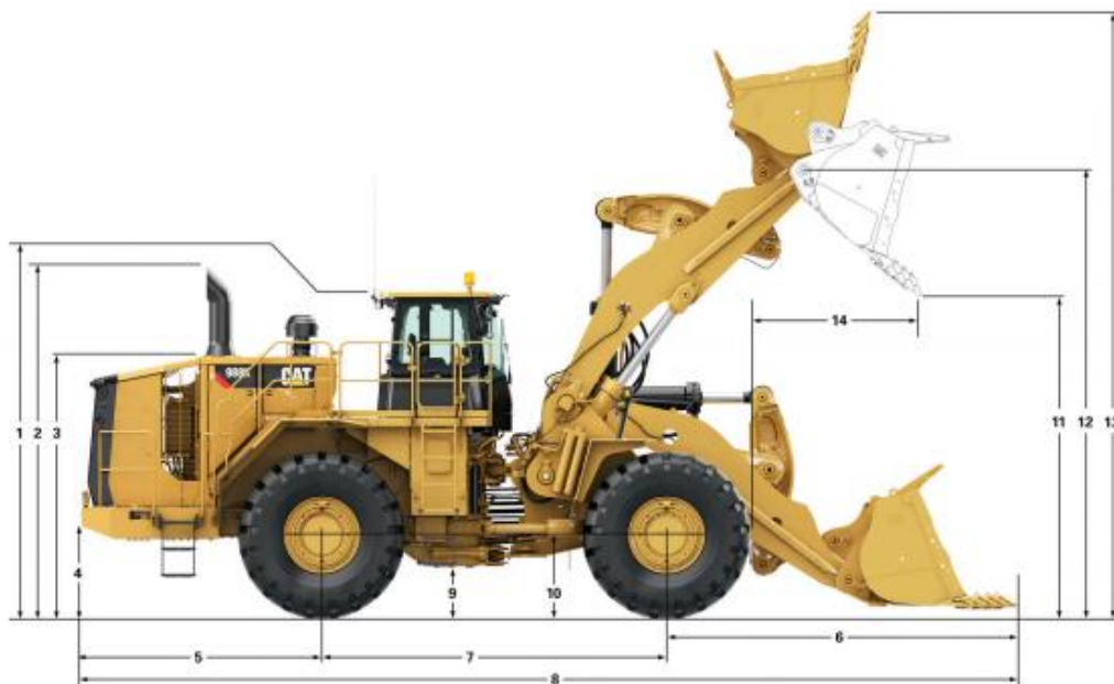
Joonis 2.4 CAT988K rataslaadur [21]
