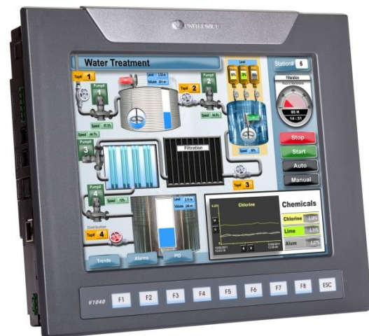
Joonis 27. PLC Unitronics Vision 1040
