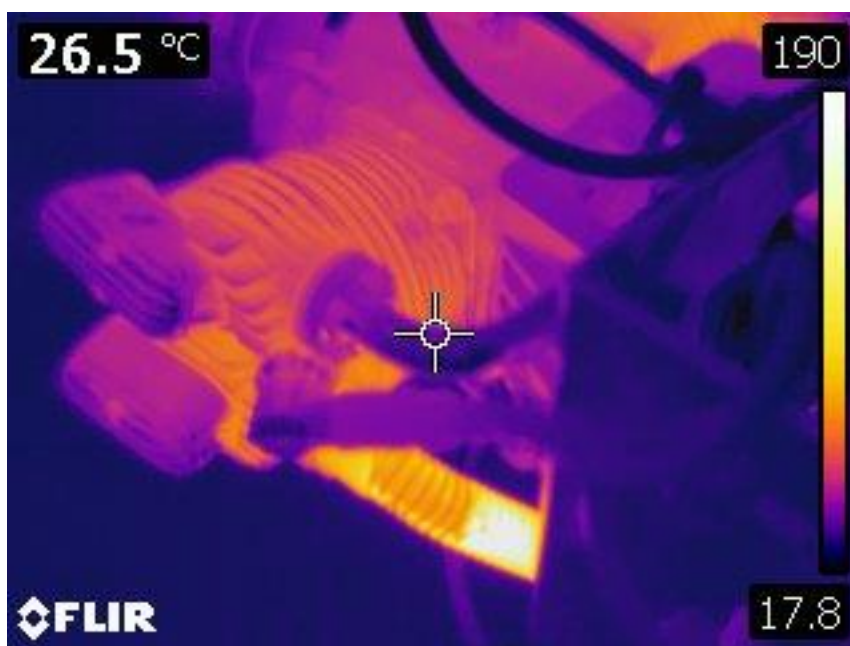
Termokaamera foto Saito FG-57T sisselaskekollektorist. Foto : Madis Parv
