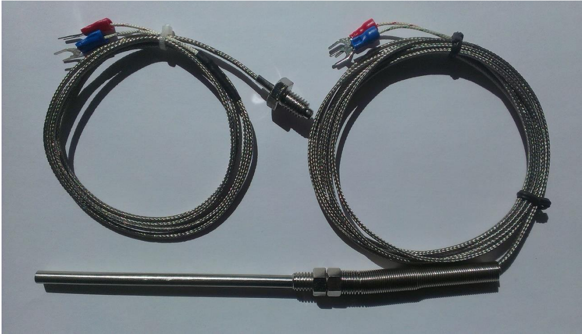
Joonis 3. Töös kasutatavad K-tüüpi termopaarid. Foto: autor
