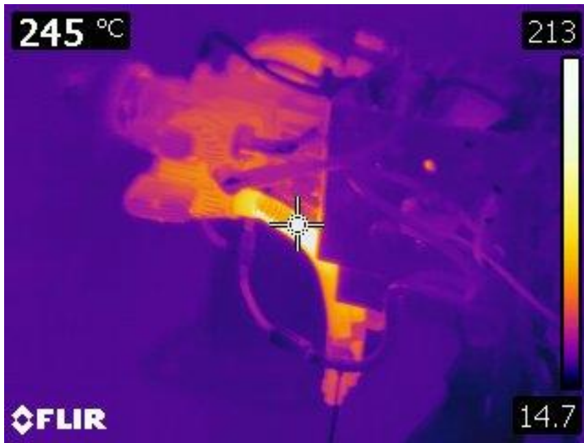
Termokaamera foto Saito FG-57T väljalaskest. Foto : Madis Parv
