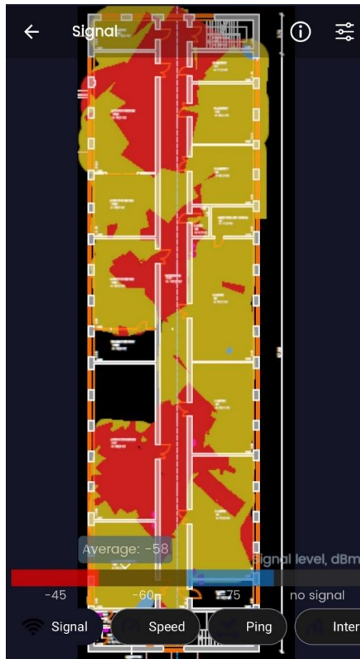
Joonis 3.7.2 Laborikorpuse teise korruse soojuskaart WiFi Heatmap – network analyzer & signal meter programmis peale katset
