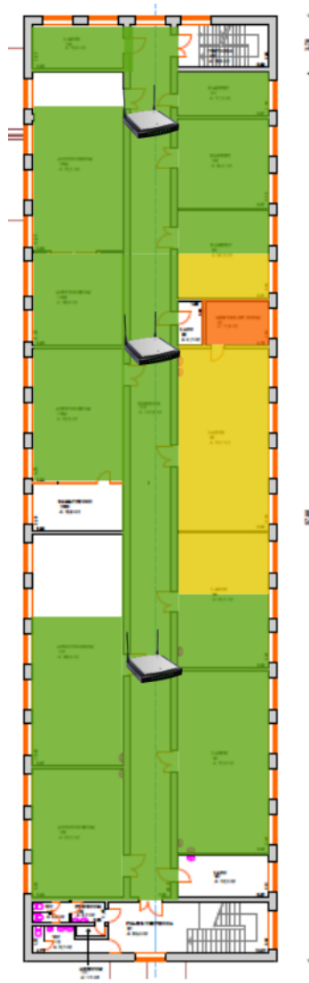
Joonis 3.7.1 Laborikorpuse teise korruse sojuskaart Ekahau HeatMapperi sojuskaardite põhjal peale katset
