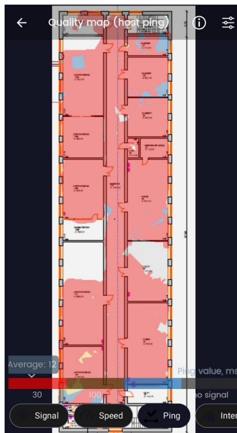
Lisa 42 laborikorpuse teise korruse andmeedastuse viivitusaja soojuskaart WiFi Heatmap – network analyzer & signal meter programmis, Ping (ms)
