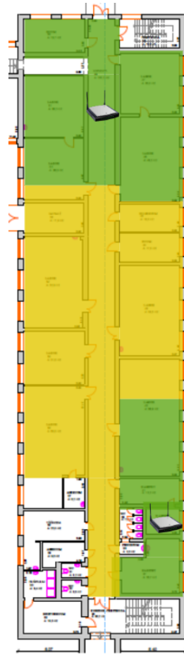
Joonis 3.5.1 Laborikorpuse esimese korruse soojuskaart Ekahau HeatMapperi soojuskaardite põhjal
