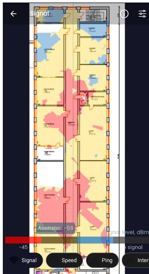
Joonis 3.6.2 Laborikorpuse teise korruse soojuskaart WiFi Heatmap – network analyzer & signal meter programmis
