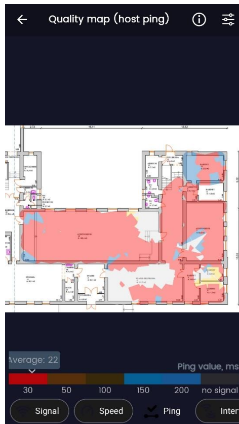
Lisa 32 esimese õppekorruse andmeedastuse viivitusaja soojuskaart WiFi Heatmap – network analyzer & signal meter programmis, Ping (ms)
