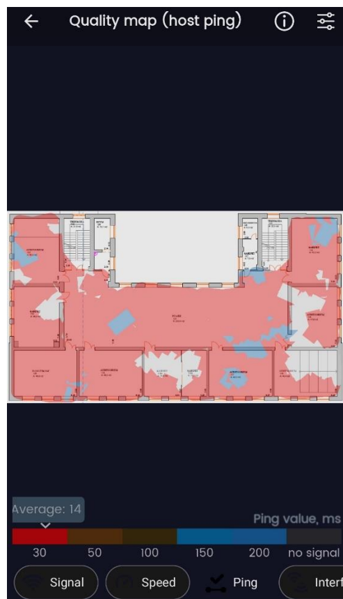
Lisa 36 kolmanda õppekorruse andmeedastuse viivitusaja soojuskaart WiFi Heatmap – network analyzer & signal meter programmis, Ping (ms)
