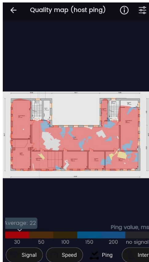
Lisa 38 neljanda õppekorruse andmeedastuse viivitusaja soojuskaart WiFi Heatmap – network analyzer & signal meter programmis, Ping (ms)
