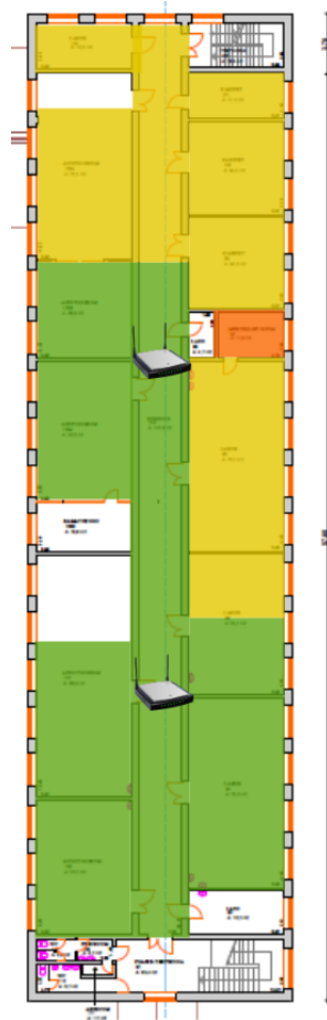
Joonis 3.6.1 Laborikorpuse teise korruse soojuskaart Ekahau HeatMapperi soojuskaardite põhjal Teises programmis on jällegi näha jaotust, mis on märgitud värvideks ja seega lihtsam on kindlaks teha, millistes kohtades on signaal lähemal -70\text{ dBm} . Halvimad tulemused olid kabinetis 204, 205, 207, 208 ja 209, kus teatud määral olid väärtused -70\text{ dBm} lähedal ja alla selle. Just nendes kabinetides tekkis mõõtmistööde käigus mitu korda lühiajalisi signaalikadusid ja taasühendamisi. Tugevat signaali on endiselt näha kabinetis 202 ning osaliselt tugevate ja osaliselt keskmiste väärtustega ruumides 213, 212, 203 ja 204a. Kõigis teistes kabinetides on traadita võrgu signaal vahemikus -50 kuni -70\text{ dBm} (vt Joonis 3.6.2).
