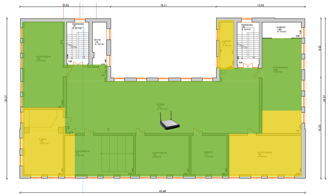
Joonis 3.4.1 Neljanda õppekorruse soojuskaart Ekahau HeatMapperi soojuskaartide põhjal
