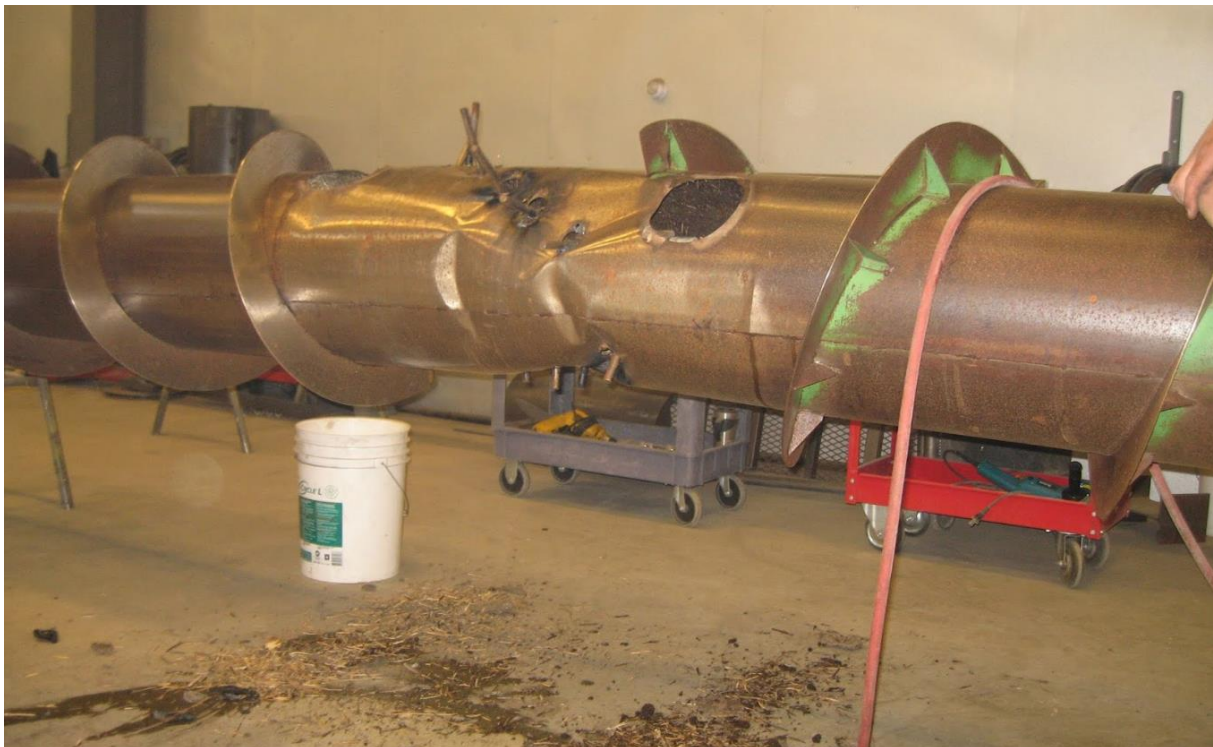
Sele 2.16. Vaade ettevõttesse Barnes Welding Inc remonti toodud kaksikteost enne remonti [19]
