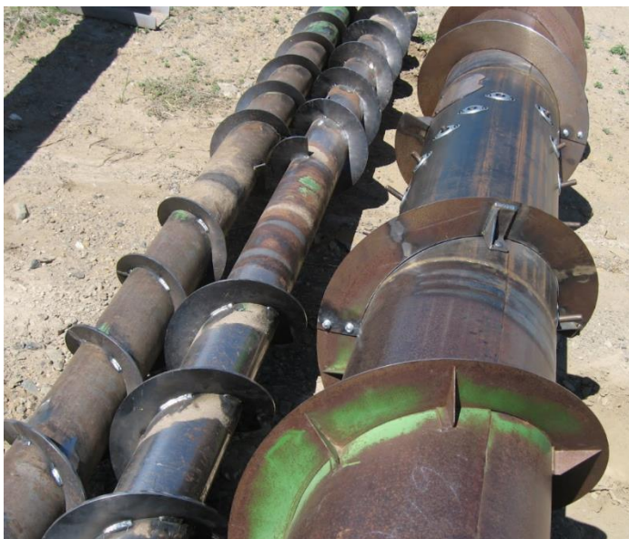
Sele 2.17. Vaade ettevõttes Barnes Welding Inc väljavahetatud keskmise sektsiooniga kaksikteole peale remonti [19]
