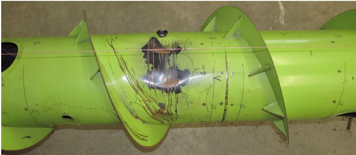
Sele 3.10. Vaade korpuse plastselt deformeerunud alale
