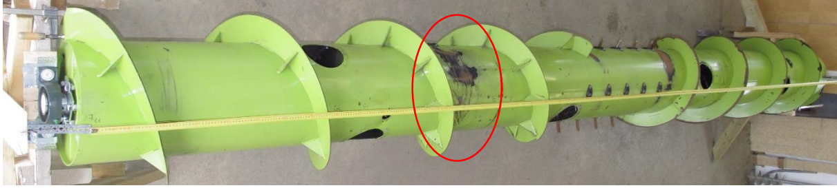
Sele 3.1. Vaade katsekehaks välja valitud kaksikteole, tähistatud on deformatsiooni asukoht
