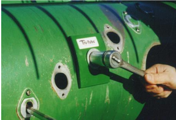
Sele 2.15. Vaade sõrme avasse paigaldatud „Tru Tube“ abinõule [16]
