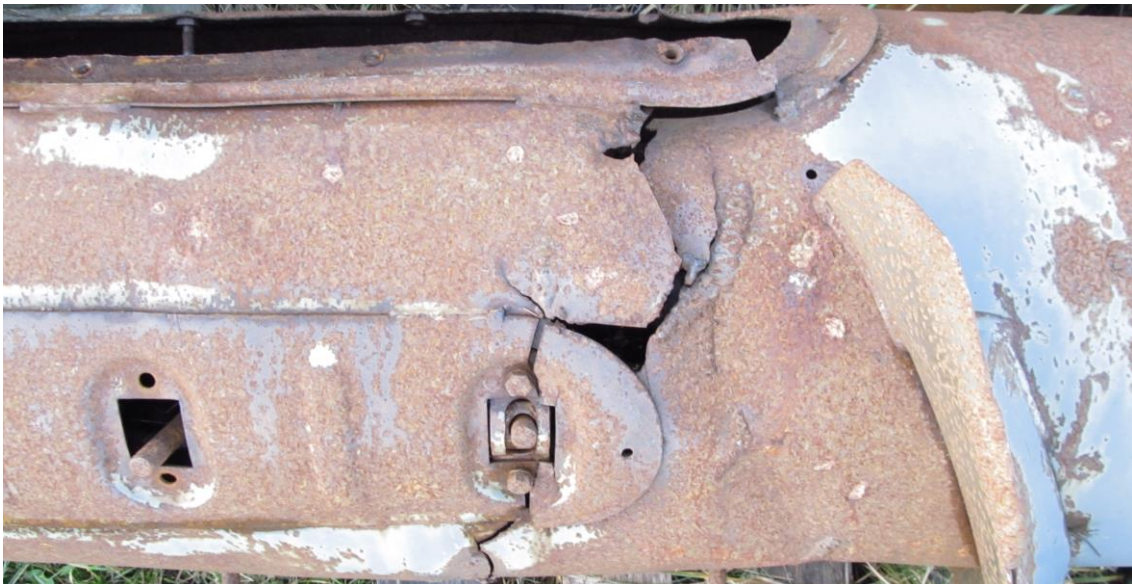
Sele 4.2. Vaade korrektselt õgvendamata kaksikteole, mille materjal on arenenud väsimuspraod kuni purunemiseni
