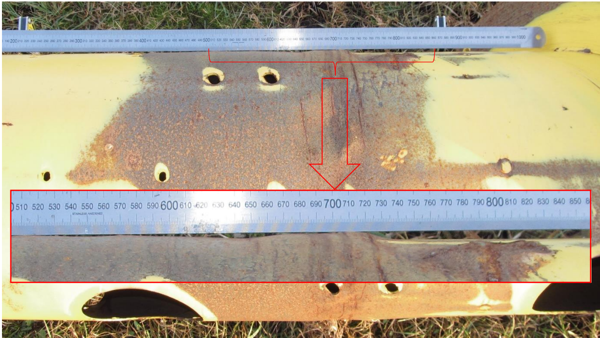
Sele 4.3. Vaade üleõgvendatud korpusele, suurendatud on väljavenitatatud piirkond
