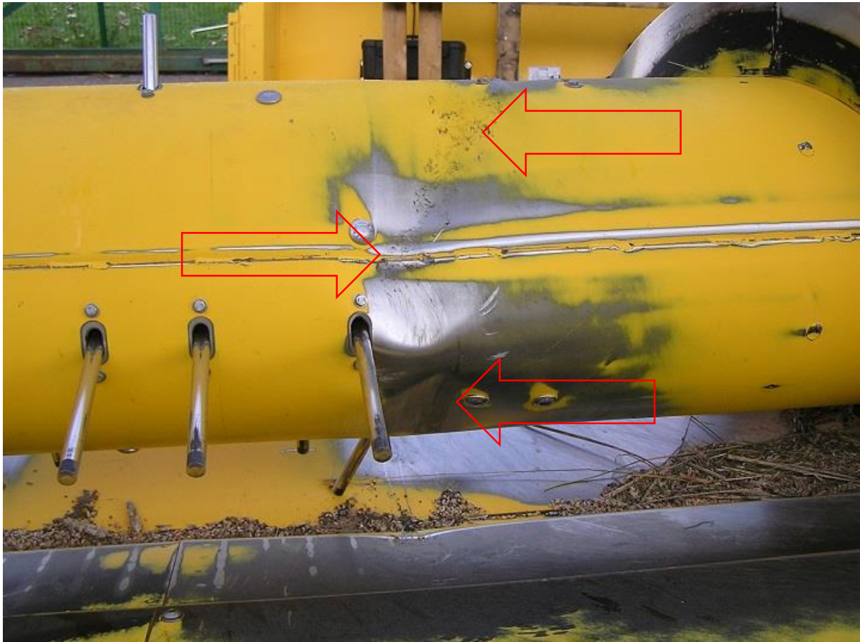
Sele 2.8. Vaade deformeerunud kaksikteo korpusele, nooltega on tähistatud mõlgid ja kraaped [7]
