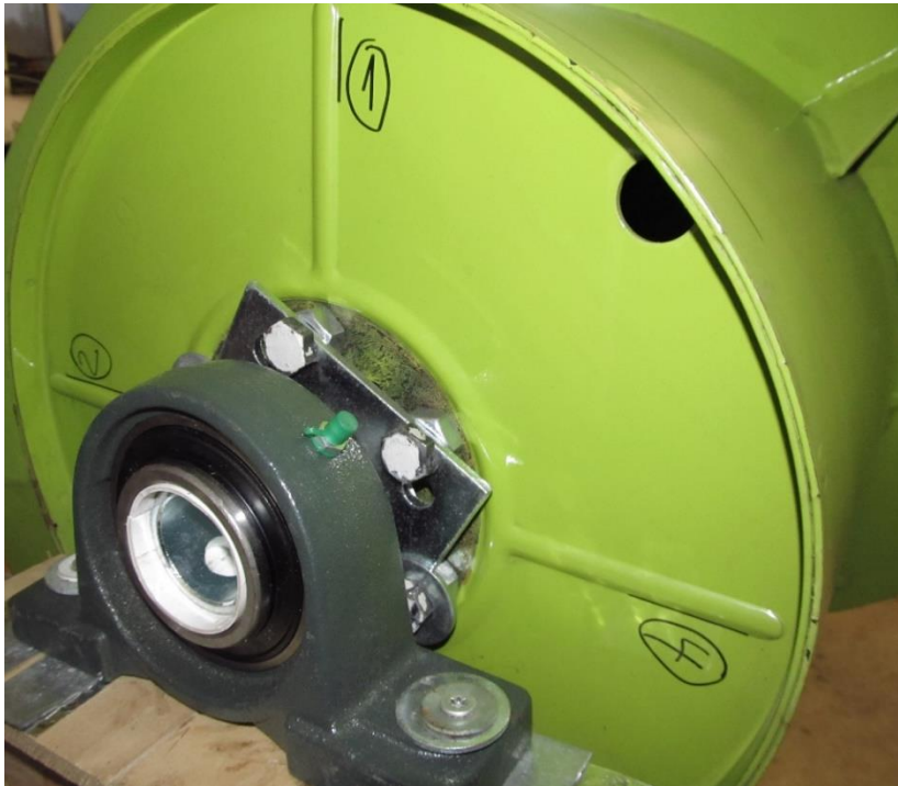
Sele nr 3.12. Vaade kaksikteo korpuse otsaplaadile, kuhu on märgitud liini numbrid
