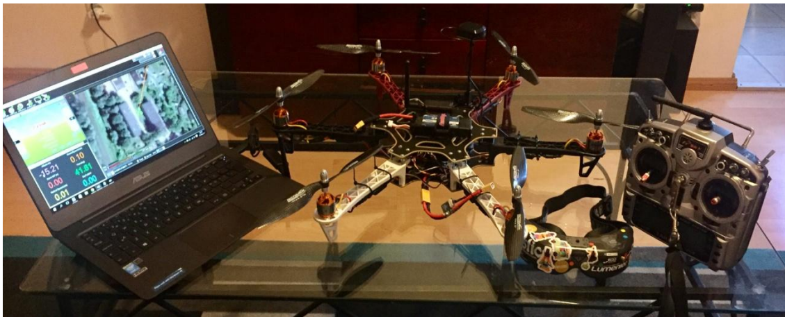
Joonis 22. GCS, multikopter, FPV prillid ja RC pult.
