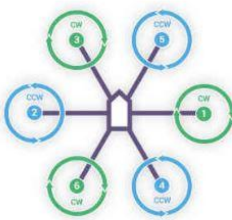
Joonis 6. ESC-de ühendamise järjekord ja vastav mootorite pöörlemise suund [27].
