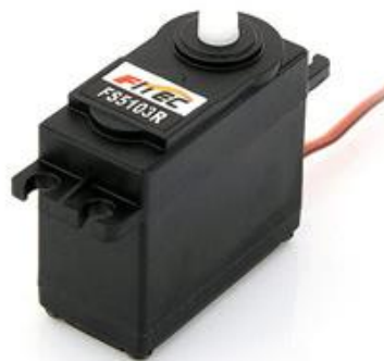
Joonis 2.18 FeeTech FS5103R pideva pöörlemisega servomootor [35]
