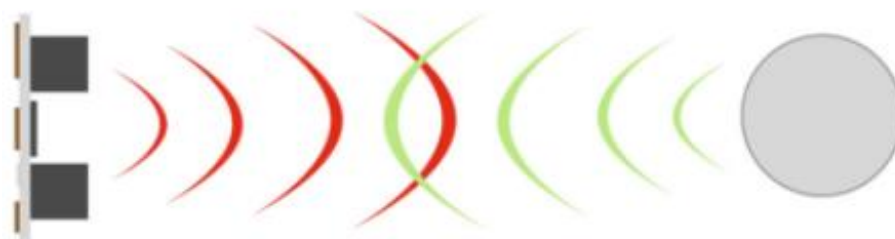
Joonis 2.12 Distantsi mõõtvate andurite tööpõhimõte [27]
