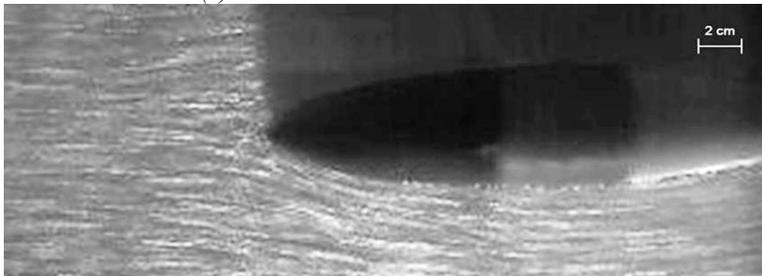
(d) Forward - backward motion in steady flow  $18.6 \text{ cm s}^{-1}$
