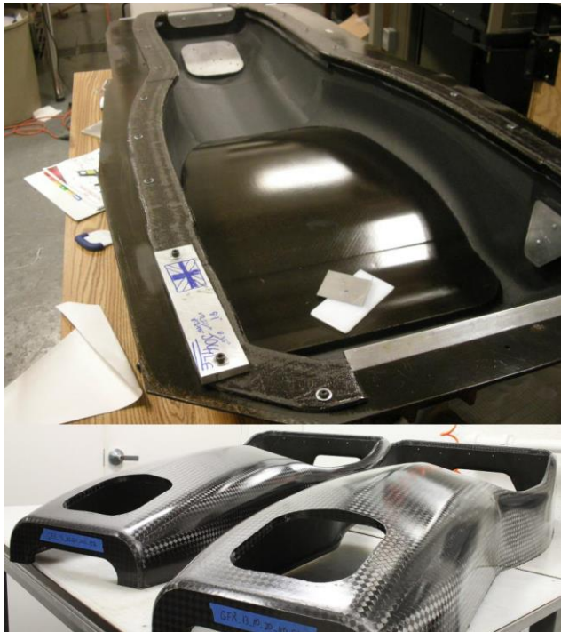
Sele 1.4. Kahest poolest valmistatud monokokk GFR 2012 [13]
