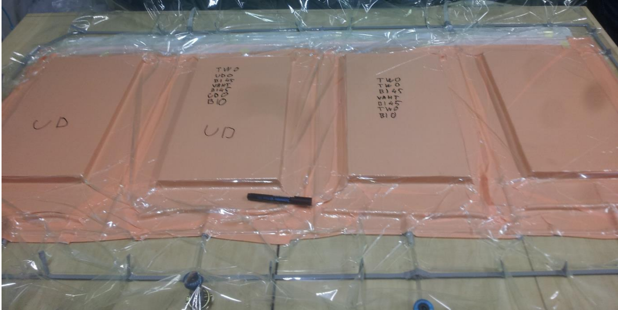
Sele 3.9. Paneeli katsekehad VAP membraaniga enne infusioonimist
