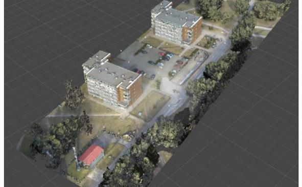
**FIGURE 3:** DENSE POINT CLOUD CREATED BY METASHAPE PRO
