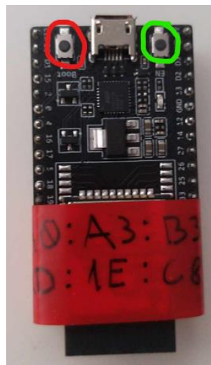
Joonis 3.8 ESP32 plaat, punane – boot nupp, roheline – EN nupp, teibil MAC-aadress
