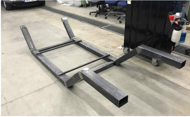
Joonis 7.10 Redelraami koostamine
