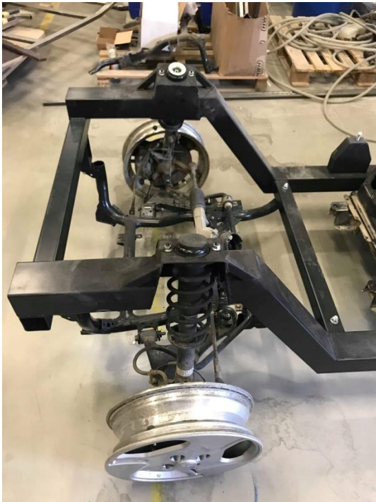
Joonis 7.16 Konstruktsiooni esisild ja kinnitused
