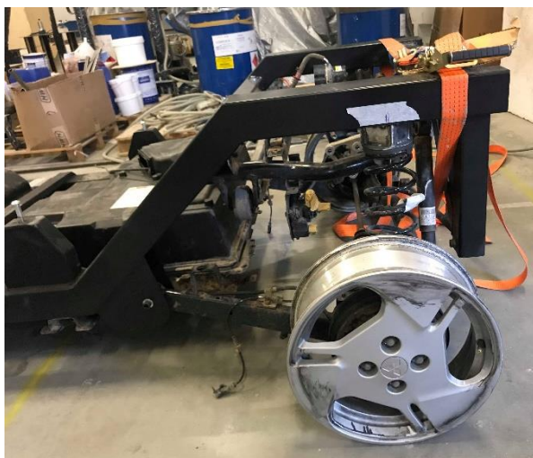
Joonis 7.17 Konstruktsiooni tagasild ja kinnitused
