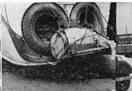
Vasakult: Tavalisi pakkideveo kärusid Soome autobusejaamades; sõiduki tagaotsa asetatud allalastav raamistik pakkide veoks; loomaveo-platvorm segaveoautobustel
