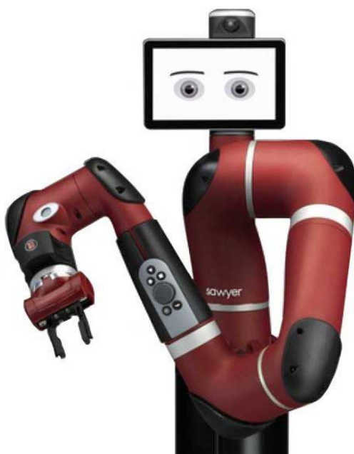
Joonis 16 - Rethink robotics Sawyer koostöörobot
