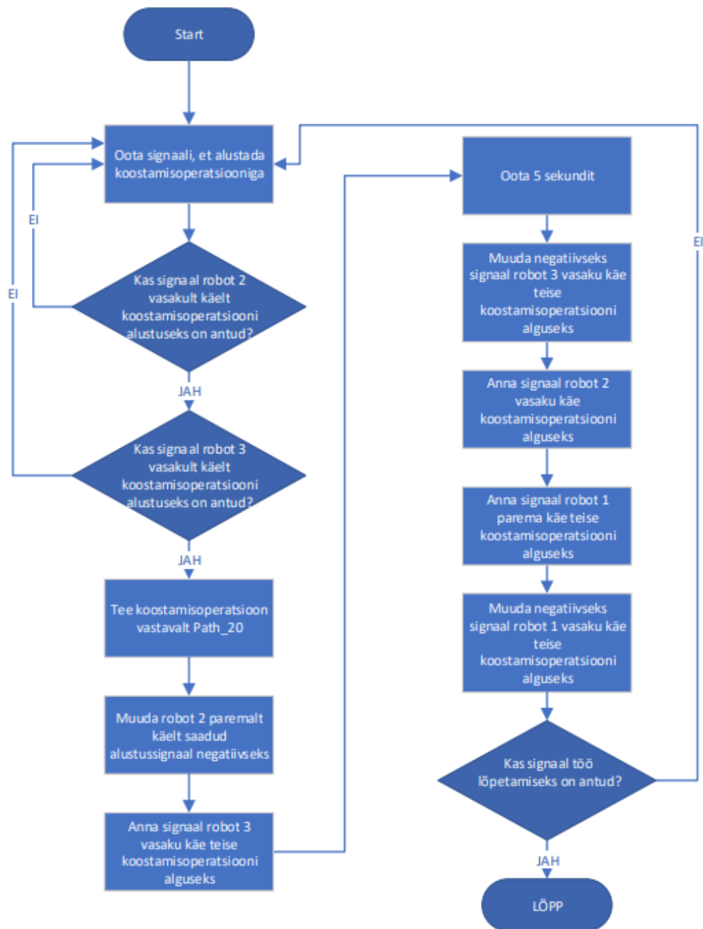
Joonis 33 Robot 2 parema käe vooskeem
