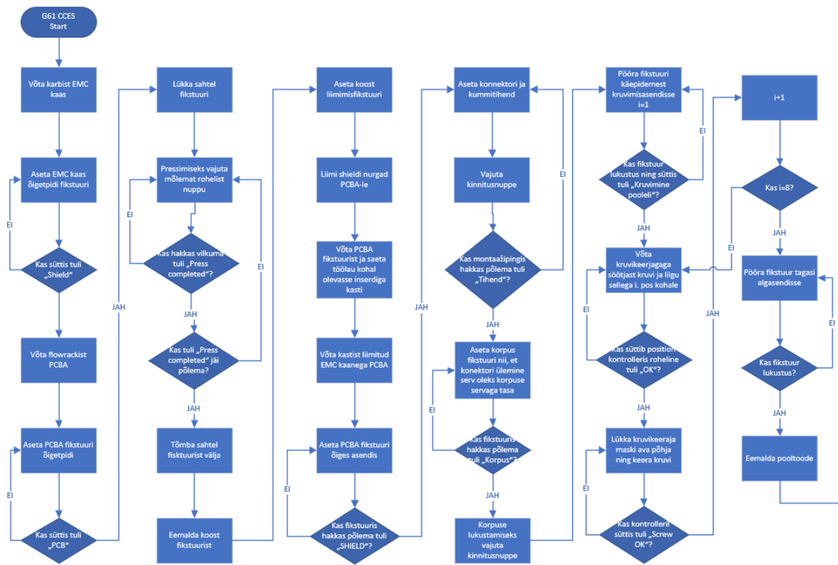
Joonis 3 Videolüliti koostamisprotsessi vooskeem osa 1
