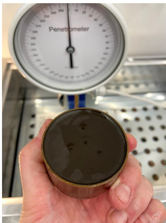
Joonis 3.5 Nõelpenetratsiooni katse läbinud proovikeha [erakogu]
