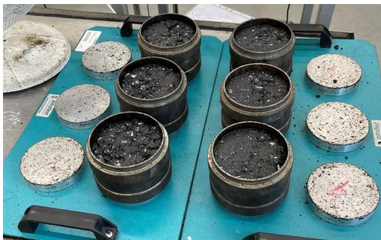
Joonis 4.7 Biobituumenist AC 16 surf segu proovikehad [erakogu]
