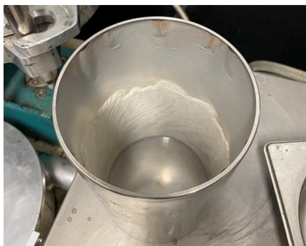
Joonis 4.4 Ekstraktoris eraldatud asfaltsegust sisalduv tolm (filler) [erakogu]
