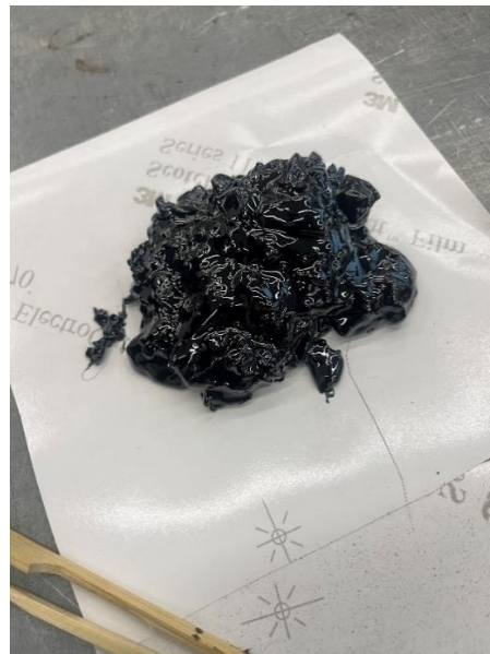
Joonis 5.4 PAV vanadamise käigus tekkinud kile, mis eBBRi katses välja jäi [erakogu]
