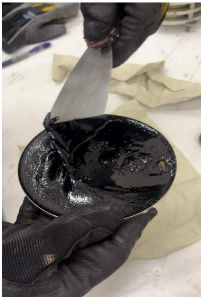
Joonis 5.3 PAV vanadamise käigus katseanumale tekkinud kile [erakogu]
