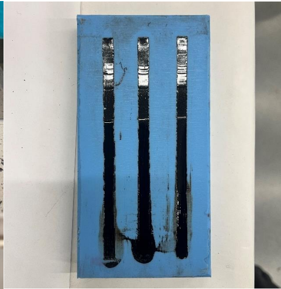
Joonis 3.13 Biobituumenist eBBRi katsekehade väljavalamine vormidesse [erakogu]
