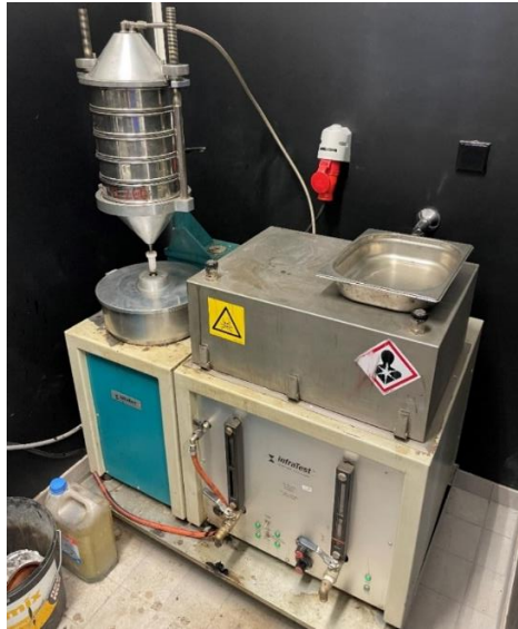
Joonis 4.2 Biobituumenist AC 16 surf segust sideaine ja täitematerjalide eraldamine [erakogu]
