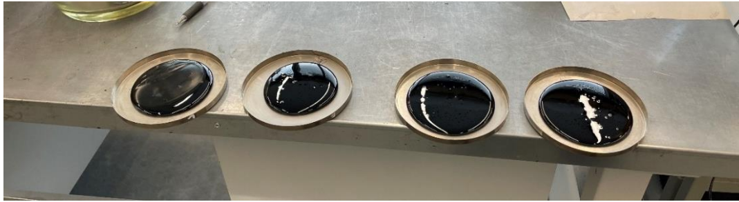
Joonis 3.10 PAV vanandamise jaoks täidetud katseanumad biobituumeniga [erakogu]
