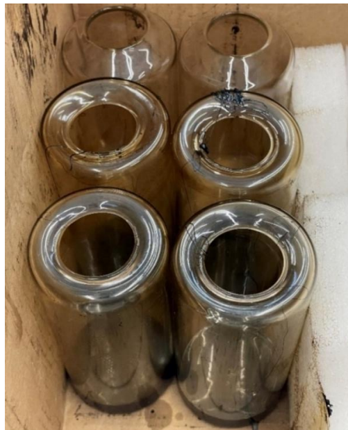
Joonis 3.9 RTFOT katse jaoks biobituumeniga täidetud katseanumad [erakogu]
