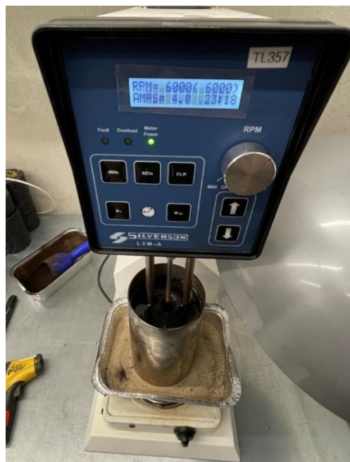
Joonis 3.4 Asfalteenidest ja malteenidest high shear mikseriga biobituumeni kokku segamine [erakogu]
