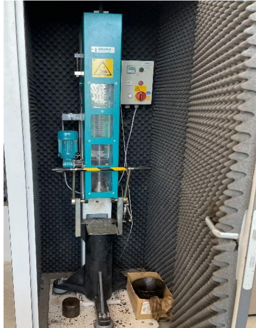
Joonis 4.6 Proovikehade valmistamiseks kasutatud lööktihendaja [erakogu]
