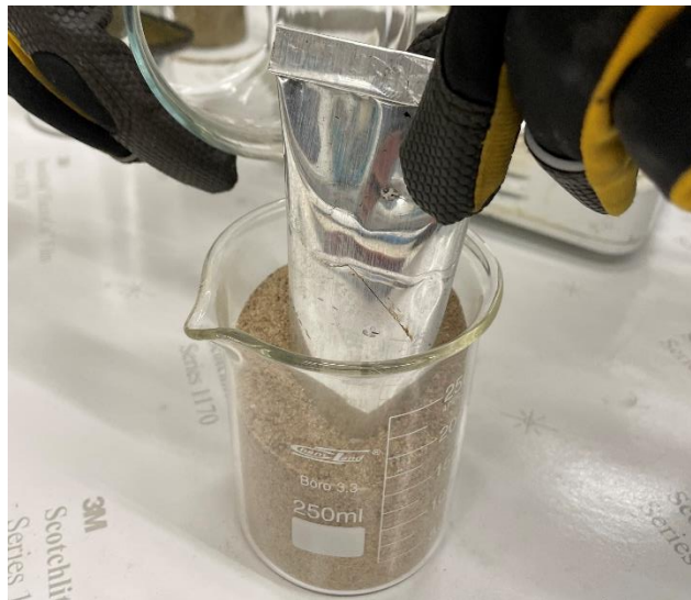
Joonis 3.8 Biobituumenit sisaldava katseanuma „Tuubi“ fikseerimine edasiseks katsetamiseks [erakogu]
