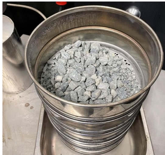
Joonis 4.3 Täitematerjalid (tardkivi killustik) peale sideaine eemaldamist ekstraktoris [erakogu]
