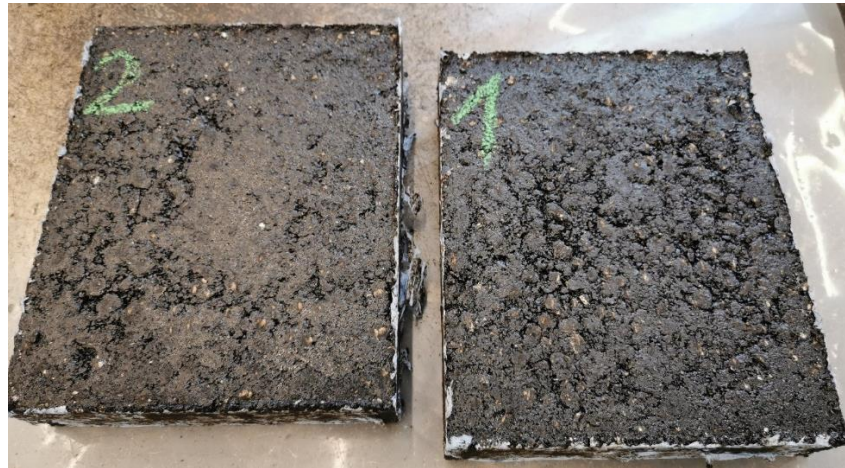
Joonis 4.9 Biobituumenist AC 16 surf segu rattaroopa katse proovikehad [erakogu]
