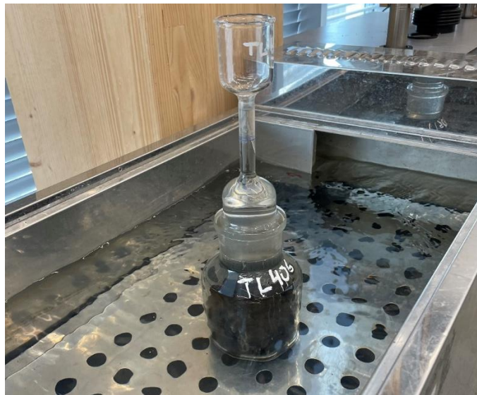
Joonis 4.8 Biobituumenist AC 16 Surf segu erimassi leidmine püknomeetriga [erakogu]
