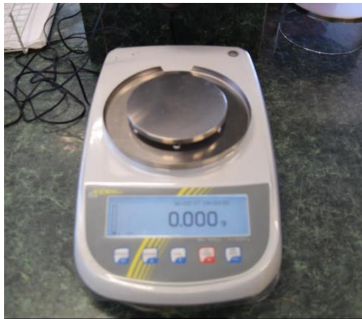
Joonis 3.4 Digitaalne kaal Kern pls 1200-3A (Max 1200 g, \pm 0,001 g täpsusega \pm 0.01\% katsekeha massist (Foto Erik Altmäe)
