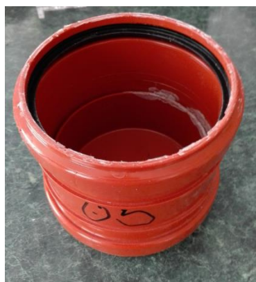
Joonis 3.6 Veeauru läbivuse katseraketise alumine osa
