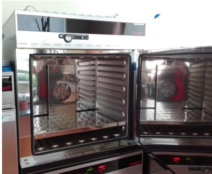
Joonis 3.2 Kuivatuskapp Memmert UFB-500
