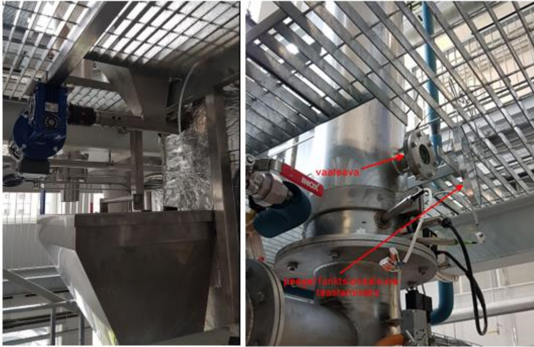
Joonis 4.4 Vaateava ja ülemise põlevkivipunkri ebafunktsionaalne asukoht
