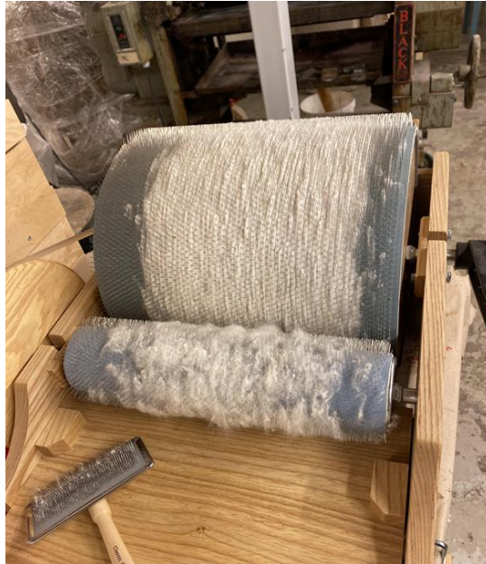
Joonis 5.12 Trummelkraasiga kiudude kraasimise protsess
