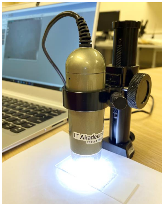
Joonis 4.1 Dino-Lite digitaalne mikroskoop
