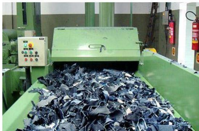
Joonis 2.2 Rõivaste purustamine riidetükkideks [8]
