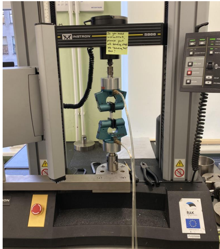
Joonis 4.2 Ülikooli tõmbekatseseade Instron 5866
