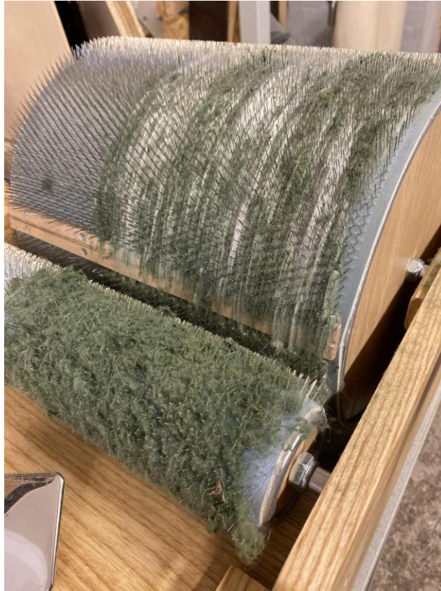
Joonis 5.14 Ümbertöödeldud kiududest lausmaterjali kraasimisprotsess
