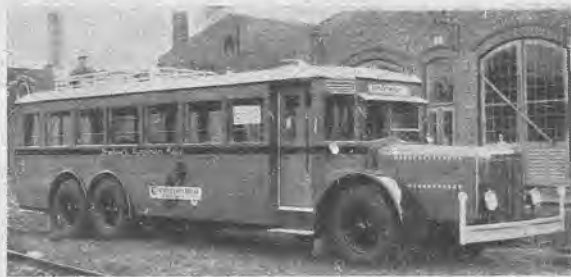
Tuntud Büssingi vabriku autobuse shassi Gredé (Kassel) kerega.
