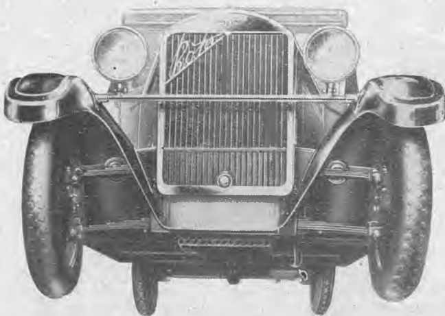
Kaheksasilindriline Rõhr auto õõtsuvalt ühendatud ratastega.
