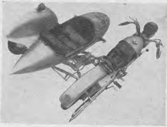
Neander mootorratas terasplekk-raamiga.
