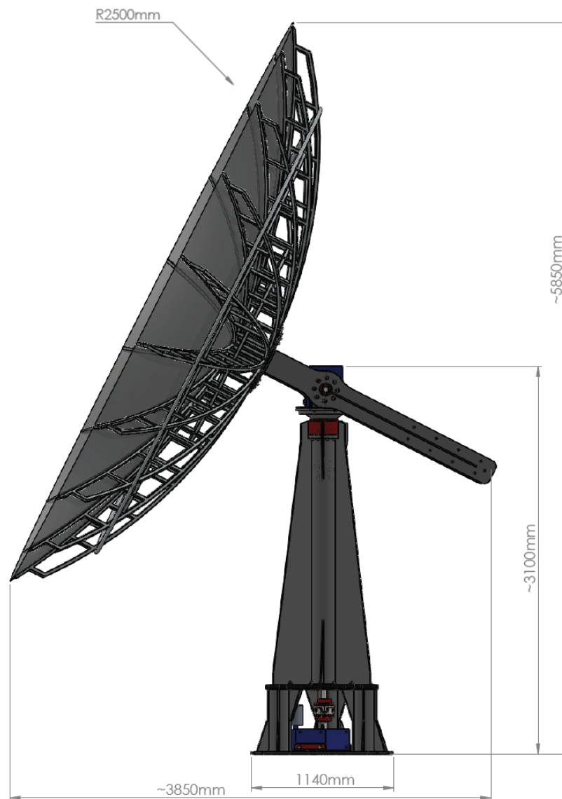
Joonis 1. Antenni mõõtmed
