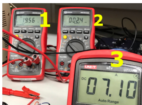
Pilt 4.3 Multimeetrite näidud. 1: toiteallika pinget; 2: šundi pingelang; 3: vool
