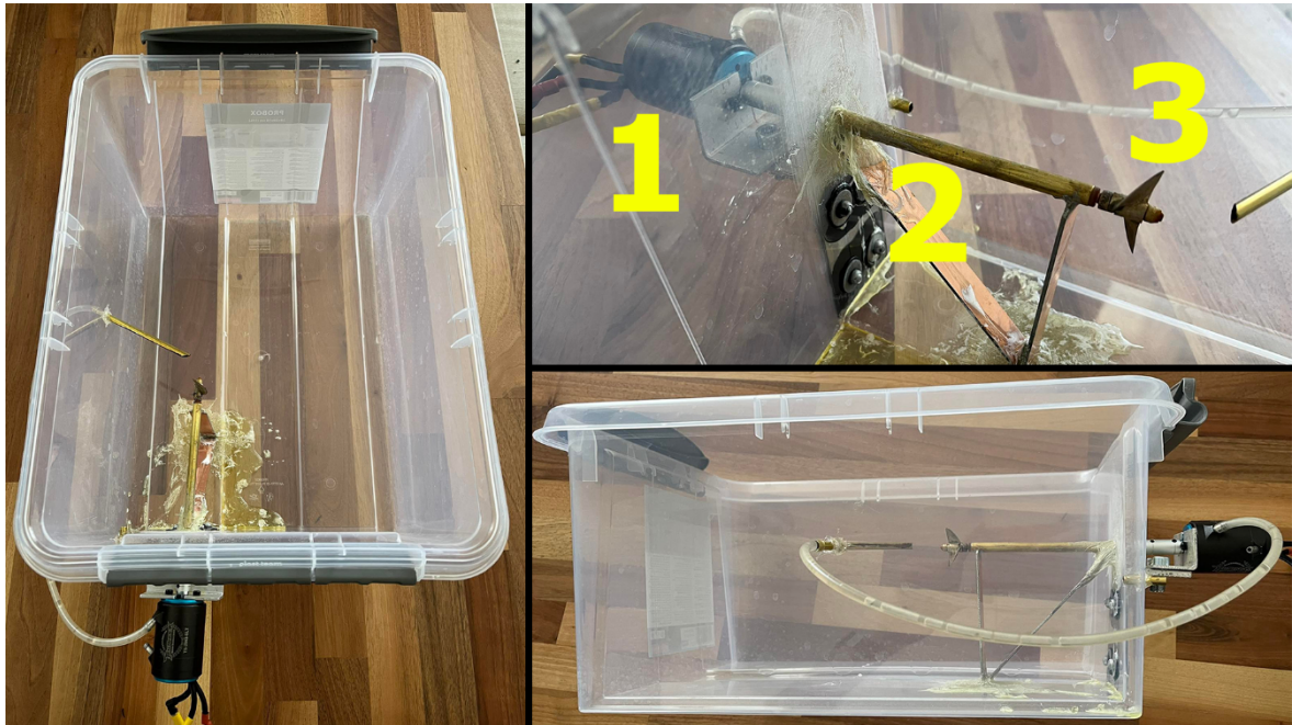
Pilt 4.7 Koormusrakis. 1: mootor; 2: võllitoru; 3: sõukruvi
