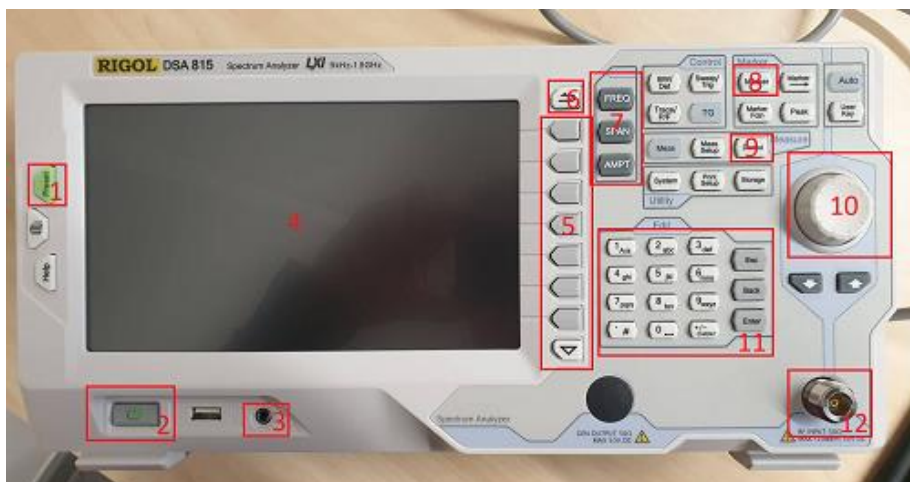
Joonis 2- Praktikumis kasutatav signaalialanalüsaator ning märgistatud vajaminevad nupud
