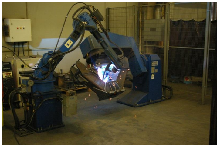
Sele 1.2. Keevitusrobot tõstukijalga keevitamas Palmse Mehaanikakojas [2]
