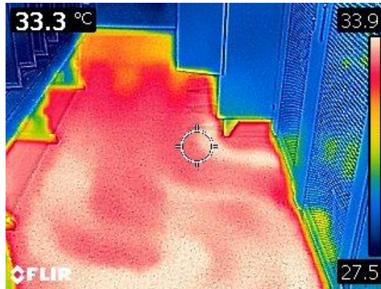
Joonis 3.2 Põrandaküttega ruumi põranda temperatuur
