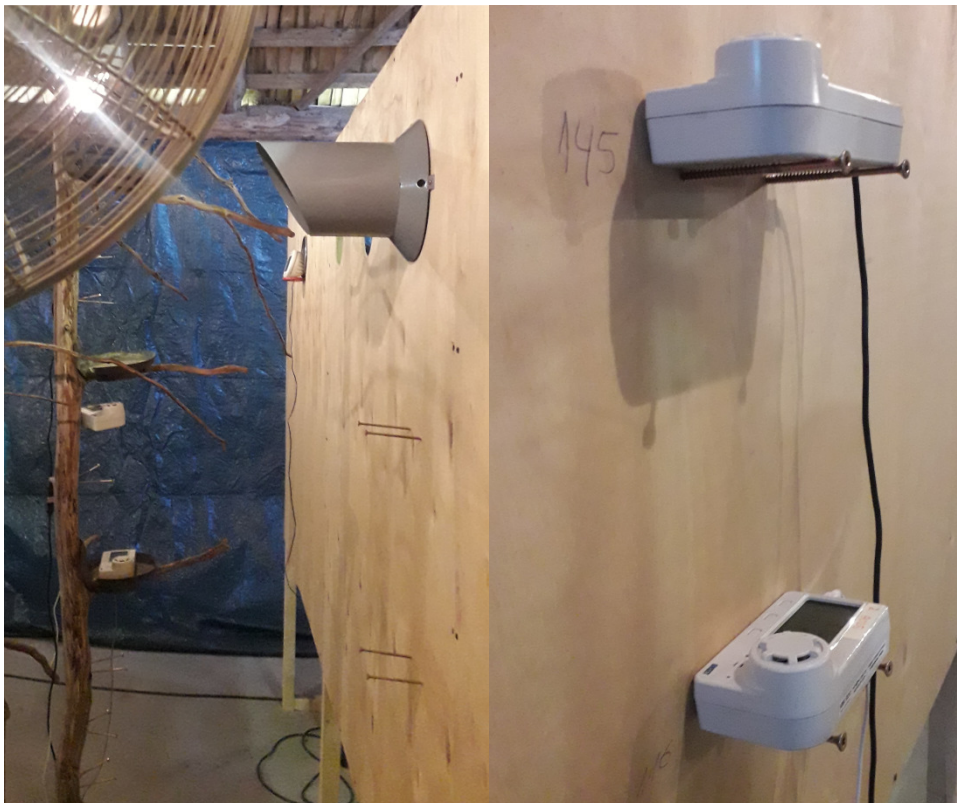
Joonis 2.17 mõõteandurite paigutus statiivil ja seinal
