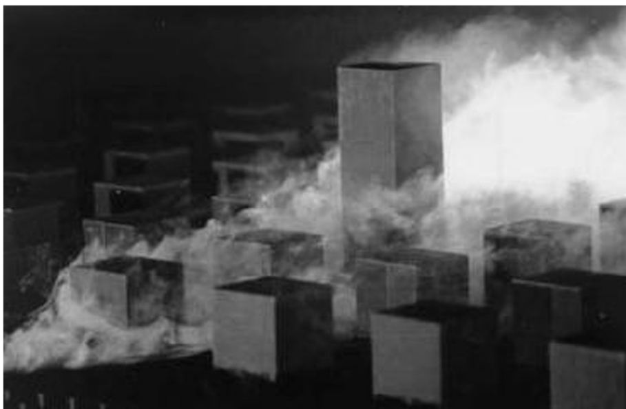
Joonis 1.4 Õhuvoolude liikumine ümber hoone [2]
