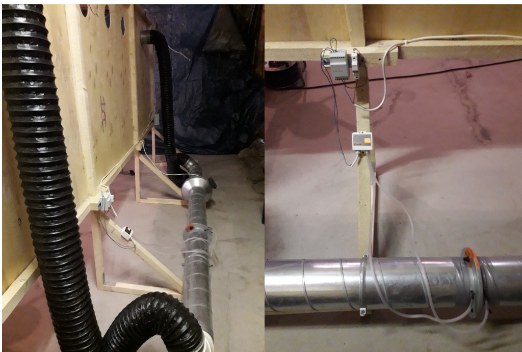
Joonis 2.4 Katseskeemi külgvaade ja õhuhulga mõõtmise seadmed
