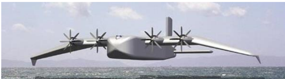
Joonis 9. Boeing Pelican ULTRA - mõõt ninaotsast sabani 152 m, tiivaulatus 109 m, kandevõime 1400t Allikas: (Knight 2002)
