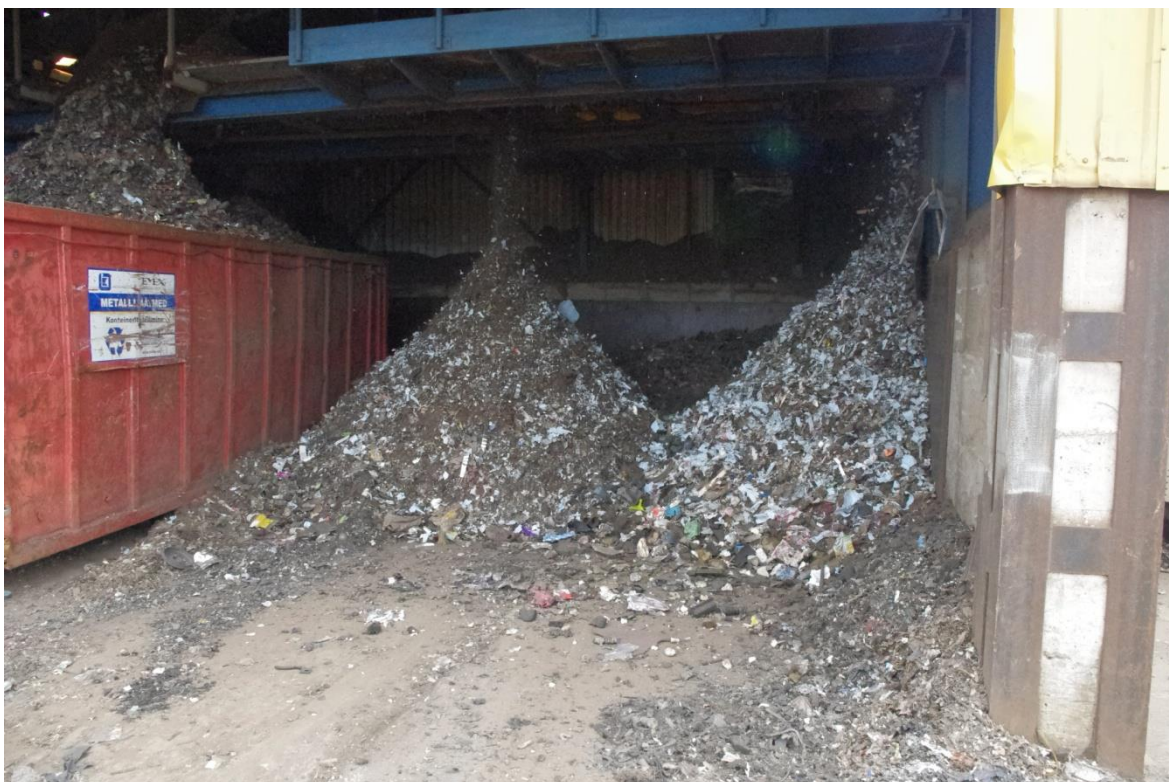
Joonis 2.13 Eraldunud mittemetalne fraktsioon
