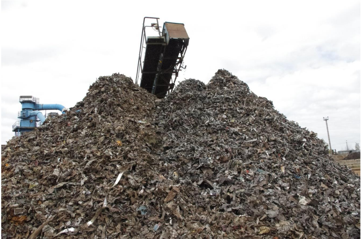
Joonis 2.14 Konveierilt tulev lõppprodukt - must metall
