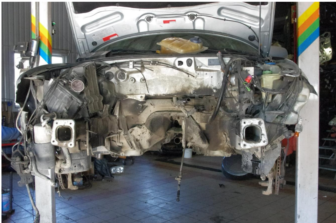
Joonis 2.6 Autoromu ilma mootori ja käigukastita
