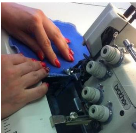
Joonis 8.3.2. Õpilane äärestamas ringikujulist detaili [autori allikas]
