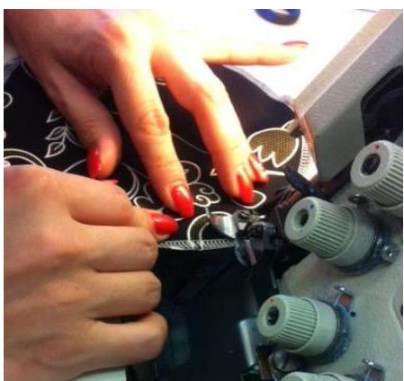
Joonis 8.3.3. Õpilane äärestamas trikooriidet [autori allikas]
