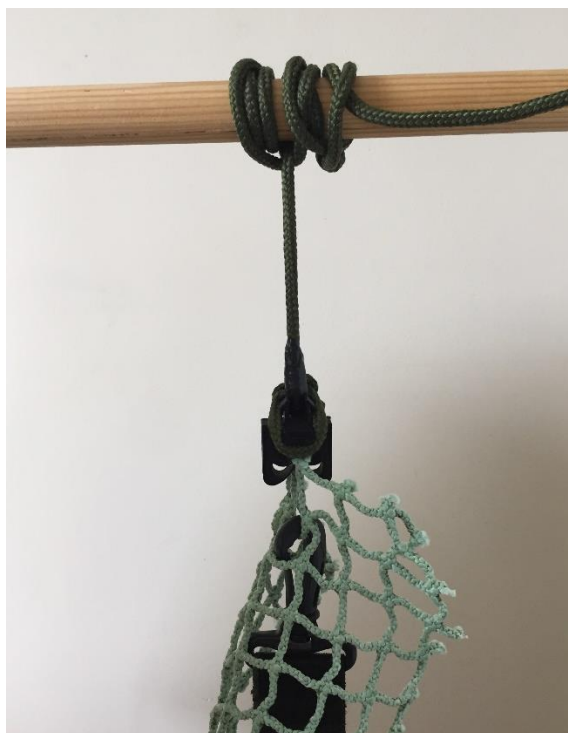
Joonis 6.19 Klambri lõksu vastupidavuse test
