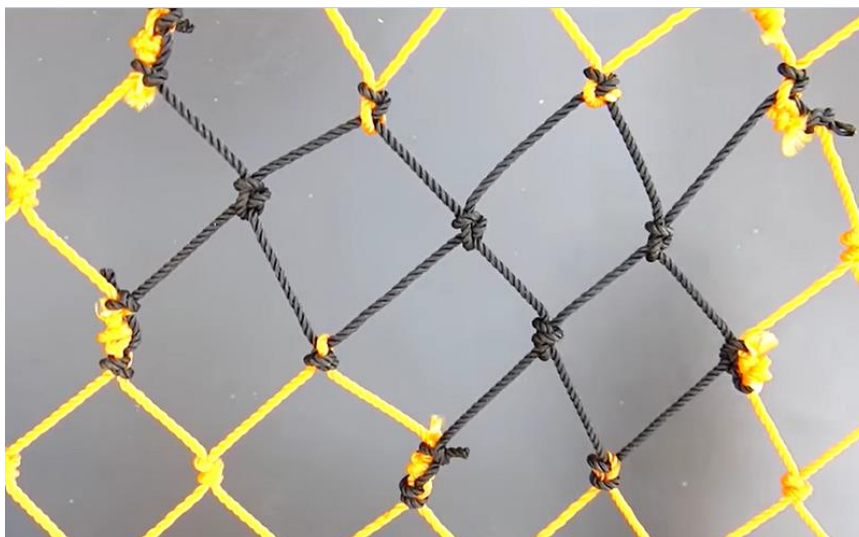
Joonis 6.2 Materjali algse oleku taastamine nõelumise/õblemisega - illustratsioon
