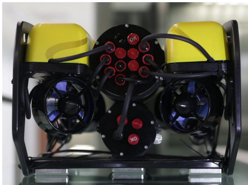
Joonis 2.3 Allveeroboti elektroonika- ja akukapsli kaablite läbiviigud
