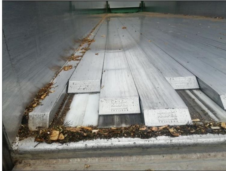
Joonis 1.5 Kõndivpõrand hakkepuidu traileris
