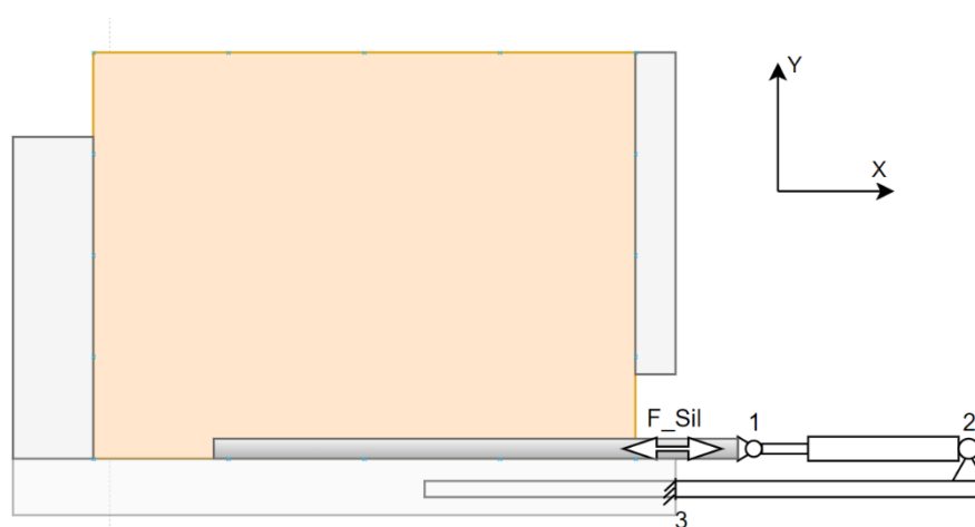
Joonis 3.9 Tugitaladele jõuskeem. 1) Silindri-raami kinnitus 2) Hüdrosilindri-tugitala kinnitus 3) Tugitala-betoonpõranda kinnitus
