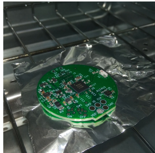
Joonis 2. Komponentidega trükkplaat rösterahjus.
