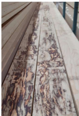
Joonis 1.22 Spoonliimpuidust pärast lihvimist välja tulnud tume liimikihi. Allikas [21]
