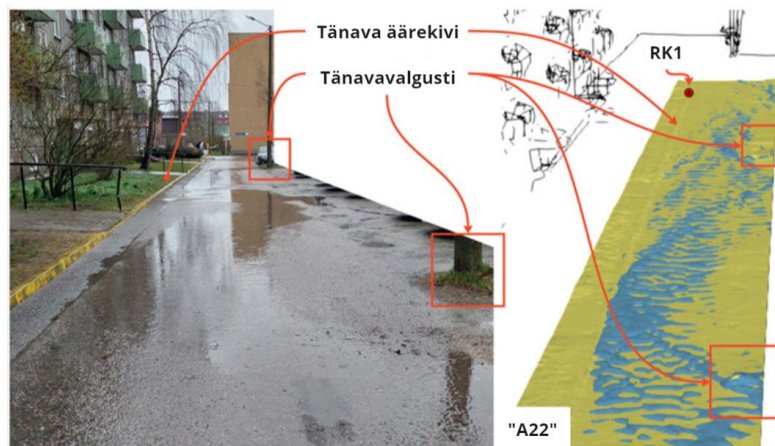
Joonis 10. Vasakul pilt tänavast (sademetel 1.7-2.5mm/h), mida CFD-ga modelleeriti A22-l (Akadeemia tee 22), paremal ParaView vaade A22 koos restkaevuga 1 (RK1) [11].
