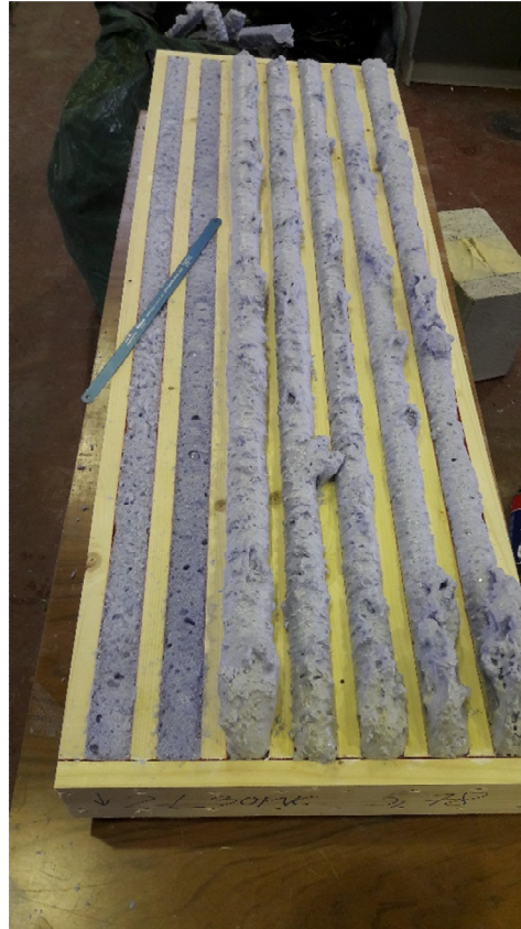
Joonis 4.11 Katsekehast väljaulatuva vahu lõikamine
