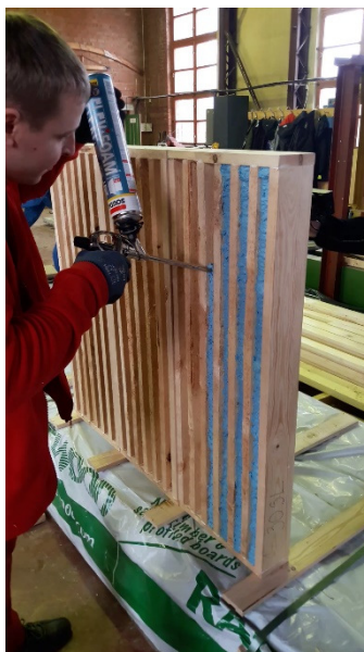
Joonis 4.5 Katsekehade montaaživahuga täitmine
