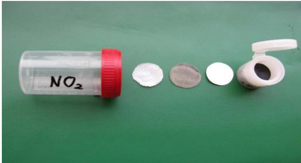
Joonis 3. Koguja ehitus. Vasakult paremale- tops, teflonmembraan, traatvõrk, reaktiividega immutatud filter ja ringikujulise avaga polüpropüleenist koguja korpus. Foto: Globe.ee
